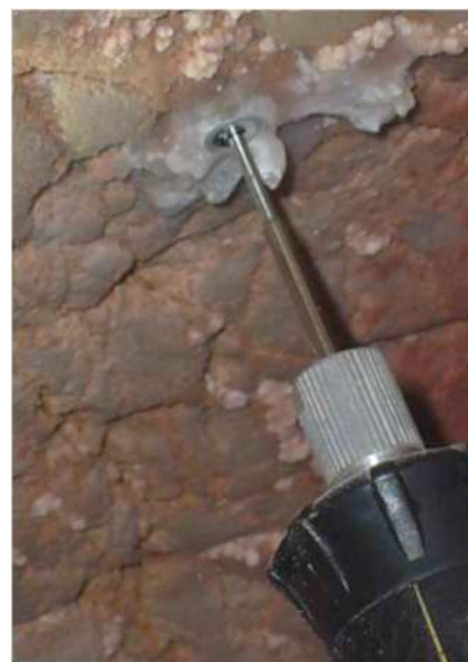
Figura 8: herramienta rotativa tipo DREMEL con disco de corte diamantado de 5 milímetros. Hoffmann et al. , 2016, p. 108.
