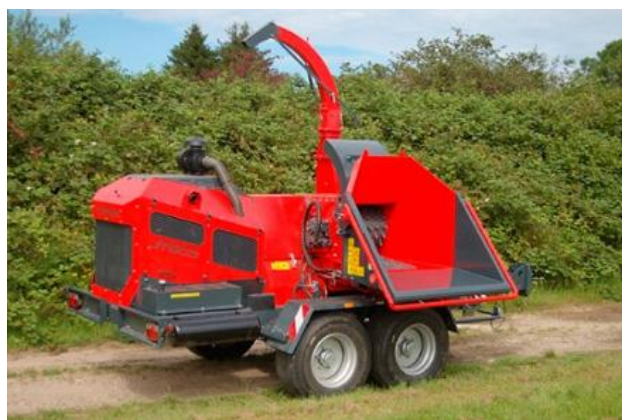
Figura 31: Astilladora móvil de tambor con cuchillas (Astilladoras y trituradoras de biomasa)
