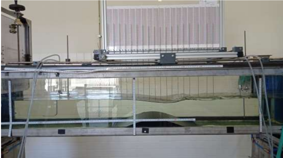
Figura 55: Transición de flujo subcrítico a subcrítico para obstáculo grande.
