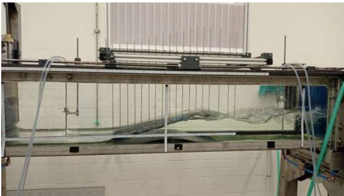
Figura 56: Transición de flujo supercrítico a subcrítico.
