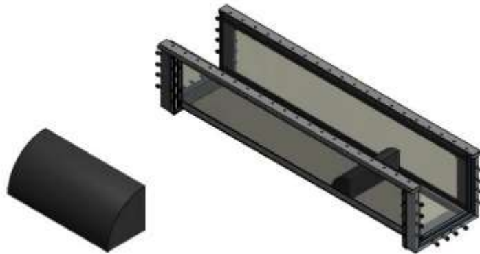
Figura 29: Vertedero de pared gruesa.
