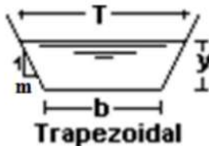
Figura 16: Sección transversal de un canal trapezoidal.
