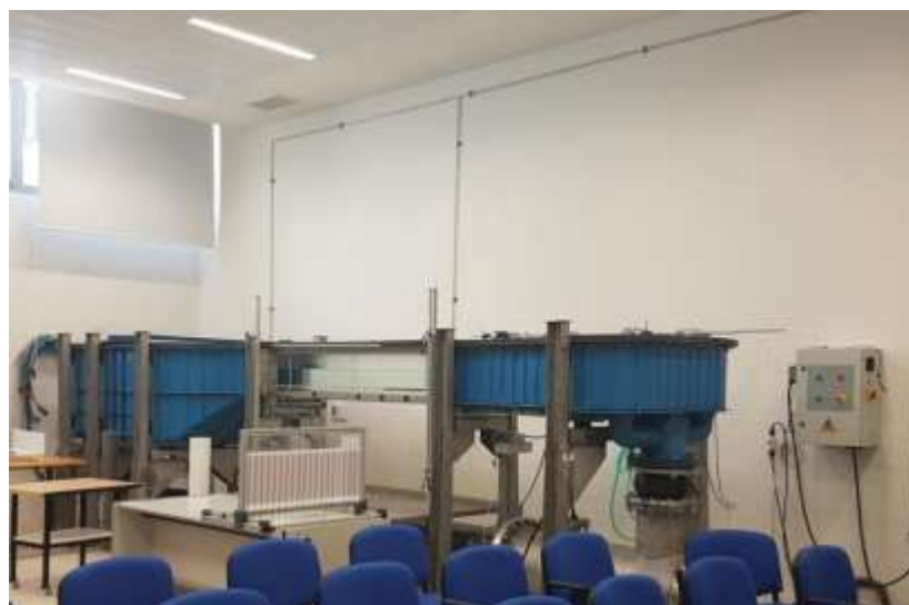
Figura 22: Canal hidráulico de la E. P. S. de Linares.
