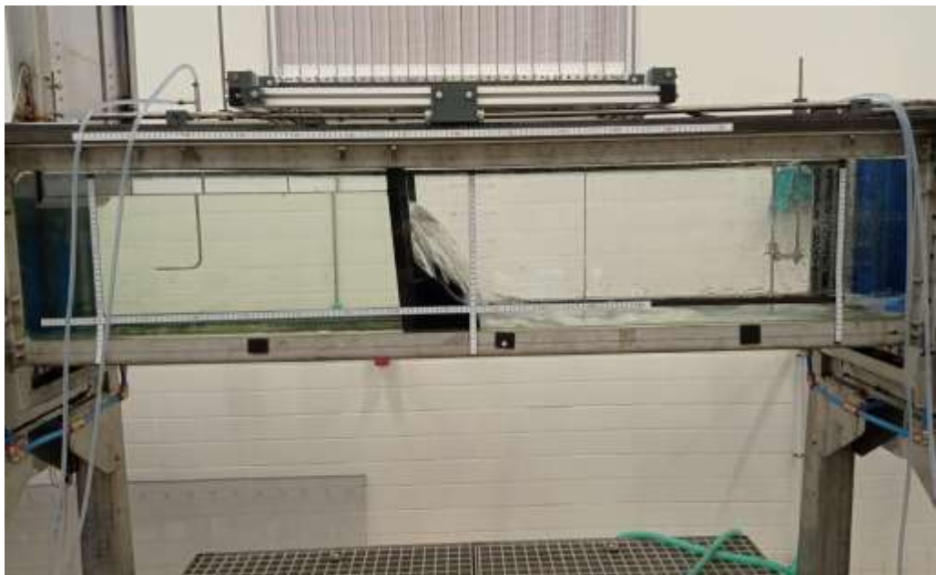
Figura 67: Vertedero rectangular en el laboratorio.
