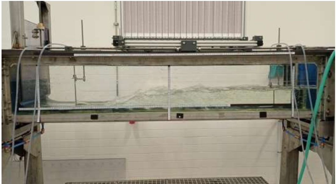
Figura 45: Resalto hidráulico en el segundo ensayo.
