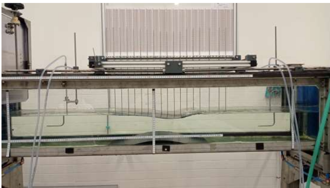
Figura 54: Transición de flujo subcrítico a subcrítico.
