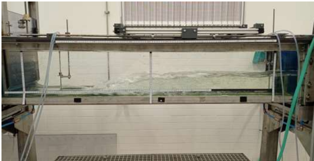
Figura 44: Resalto en el primer ensayo.
