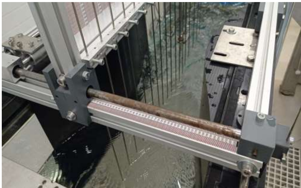
Figura 47: Ensayo del estrechamiento lateral en el laboratorio.
