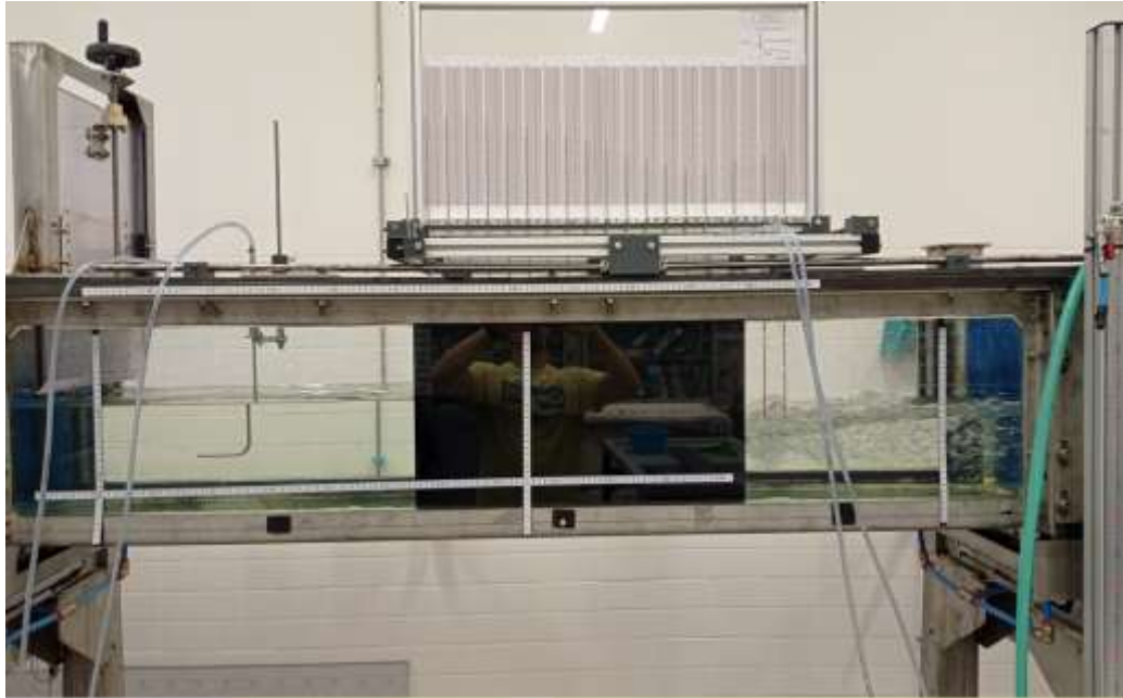
Figura 50: Realización del ensayo estrechamiento lateral.
