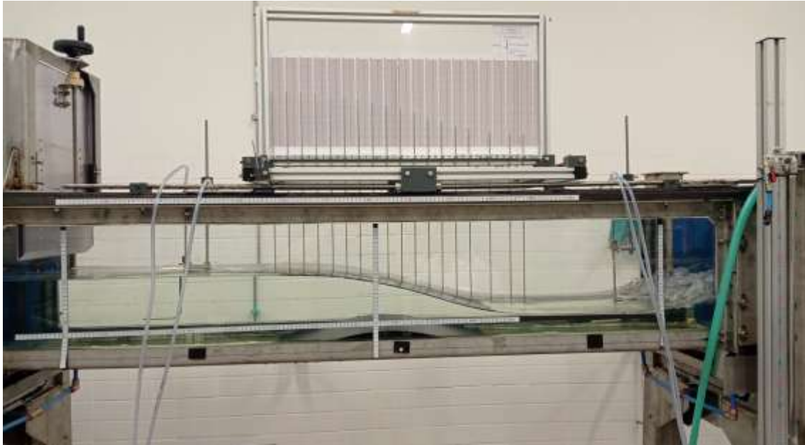
Figura 53: Transición de flujo subcrítico a supercrítico.
