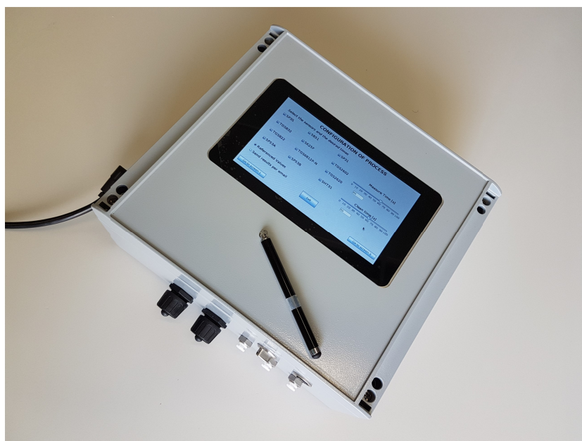
Figura 3.11: Nariz electrónica en funcionamiento
