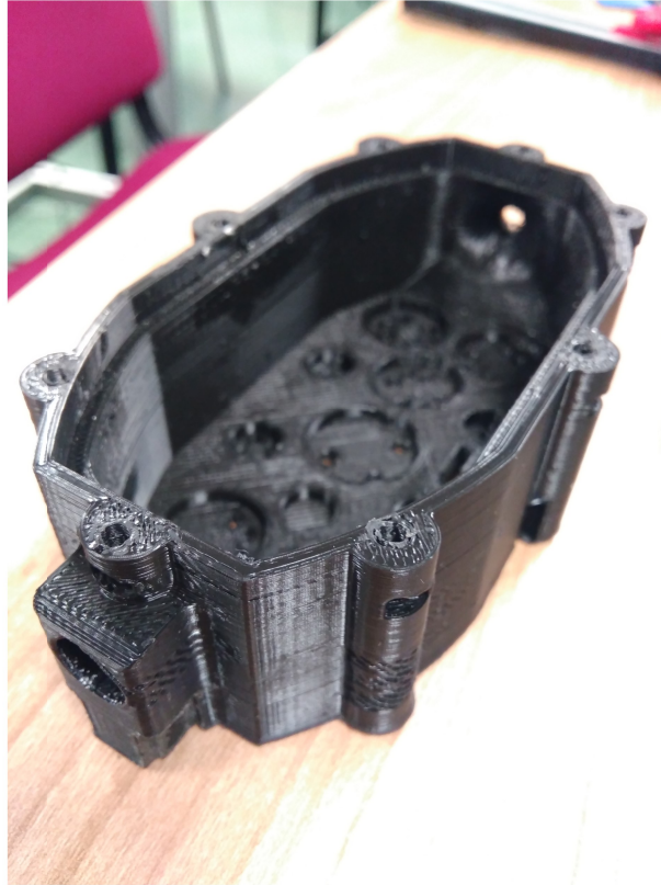
Figura 2.11: Impresión 3D del primer prototipo
