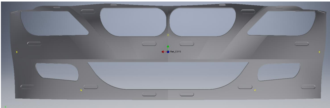
Ilustración 62. Ubicación puntos de inyección.
