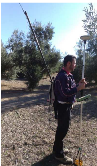
Figura 37. Ilustración de la colocación de la antena del equipo móvil en una posición más elevada.
