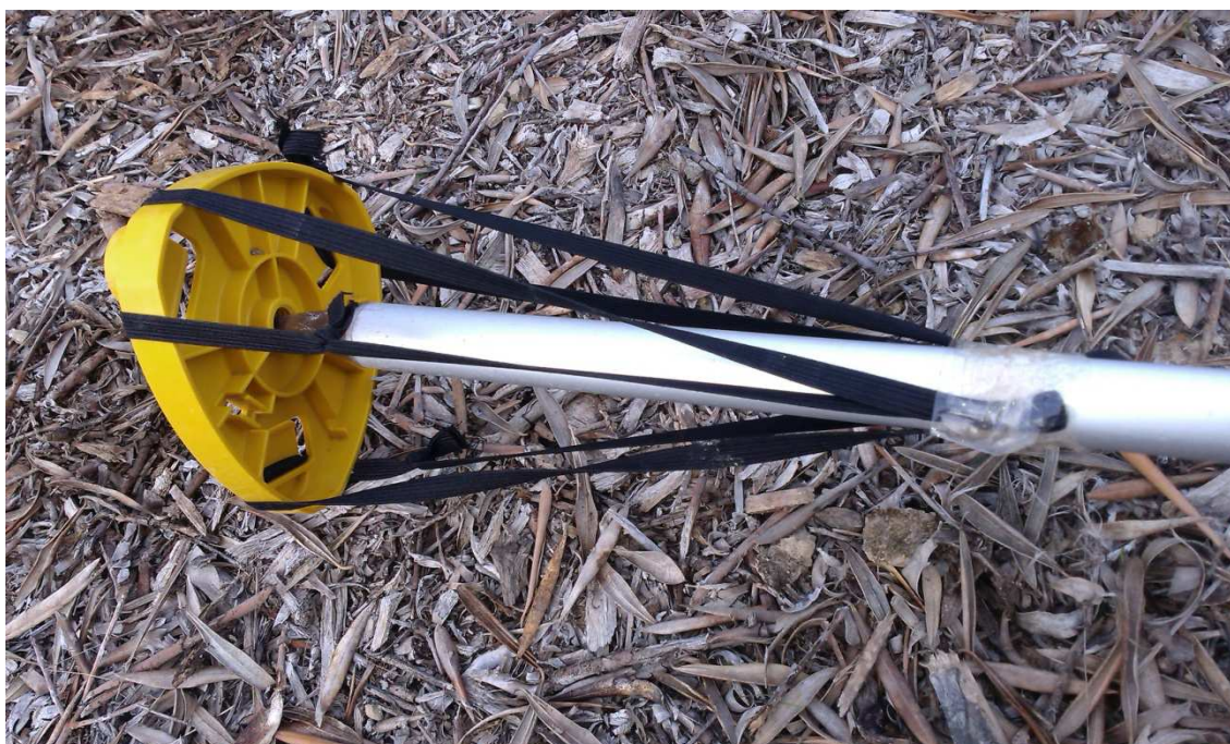
Figura 35. Ilustración del acoplamiento de la tapa de un trípode en la parte inferior de un jalón.
