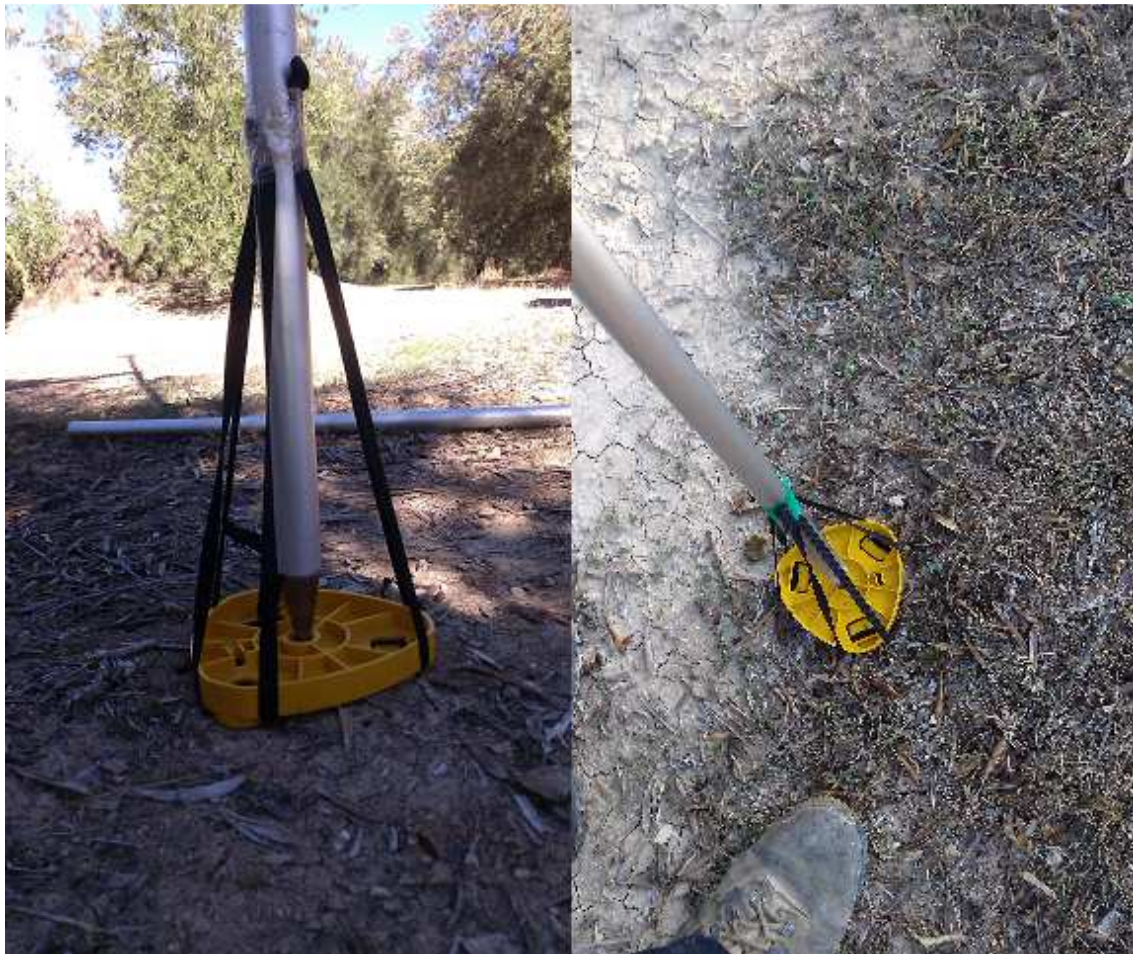
Figura 36. Ilustración del montaje adoptado para minimizar errores en la captación de la superficie.
