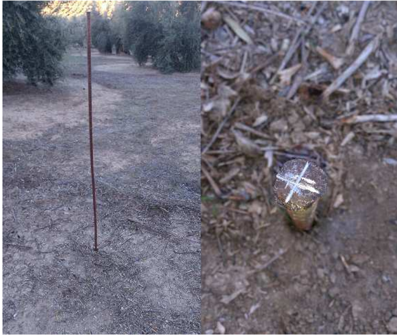
Figura 39. Ilustración de la base REF-CAPITAN y detalle de la marca sobre la que estacionar.
