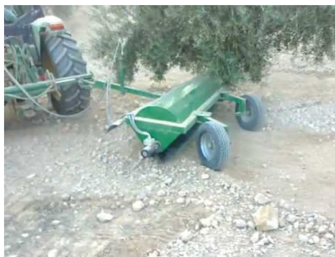
Figura 13. Ejemplo de cepillo giratorio utilizado en la limpieza de la zona bajo copa en olivar.
