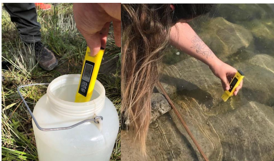
Imágenes 52 y 53. Mediciones de la temperatura a 1m de profundidad y del pH del río.
