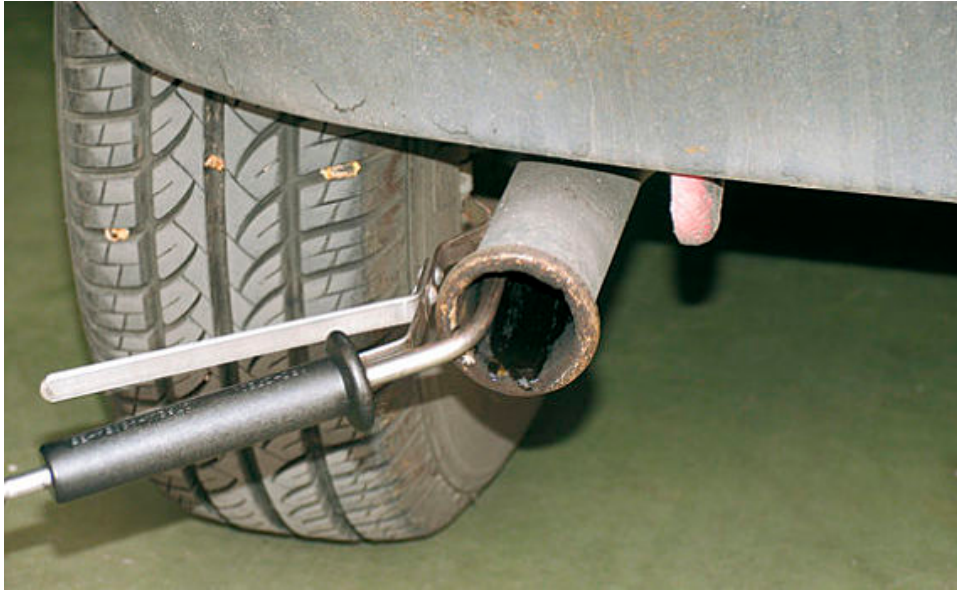
Figura 6: Sonda de medición de gases de combustión en un vehículo de gasolina (Fuente: RACE).
