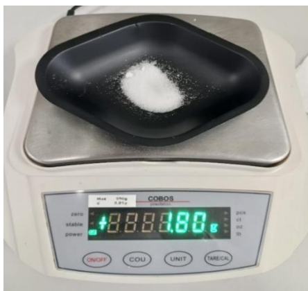
Figura 4.2.5. Balanza utilizada para el taraje del sustrato de cloruro sódico (NaCl). Fuente: Elaboración propia.
