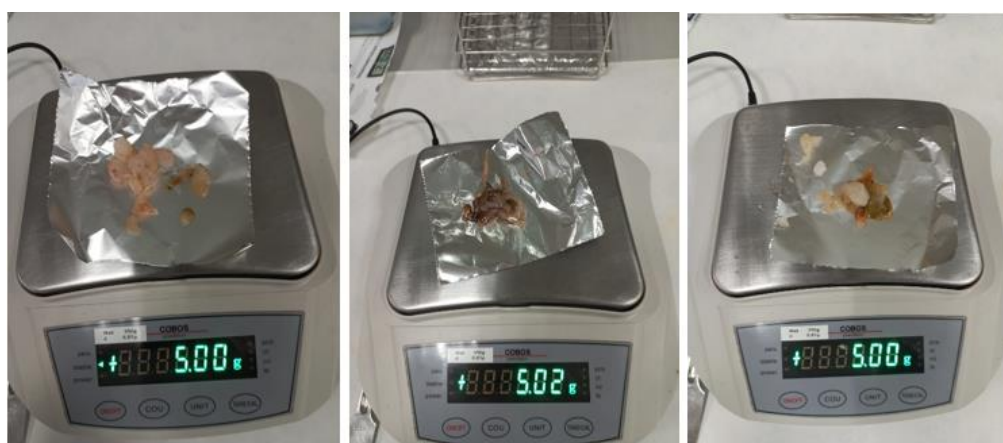
Figura 4.3.2. Pesaje de la cantidad necesaria de marisco (5 gramos) para distintos alimentos previo al proceso de homogeneizado. Fuente: Elaboración propia.
