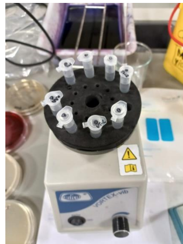
Figura 4.3.7. Vórtex de agitación con los distintos tubos Eppendorf con las soluciones seriadas del alimento. Fuente: Elaboración propia
