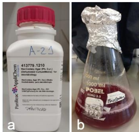
Figura 4.1.2.1. Bote con el sustrato sólido del medio MacConkey (a) y solución sellada y esterilizada del mismo (b). Fuente: Elaboración propia.
