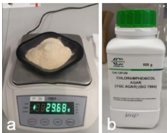
Figura 4.1.5.1. Taraje de sustrato de medio YGC en balanza de precisión (a) junto a su correspondiente recipiente (b). Fuente: Elaboración propia.
