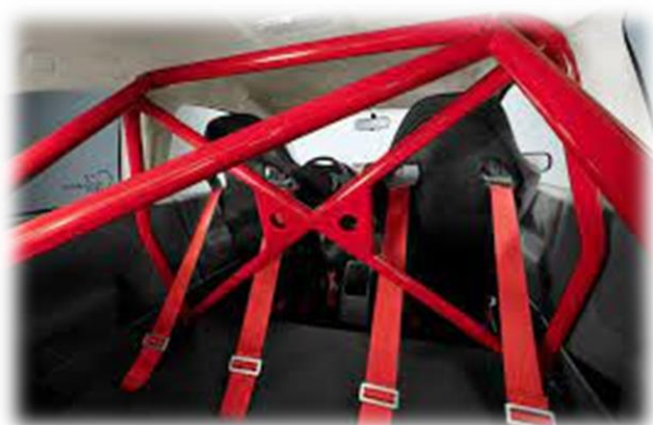
Figura 4. Estructura interna antivuelco.
