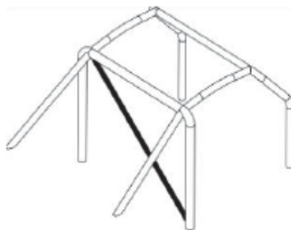
Figura 23. Tirante transversal arco principal. 12
