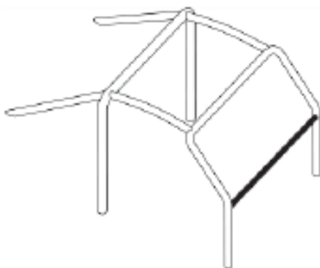
Figura 35. Refuerzo arco frontal. 24
