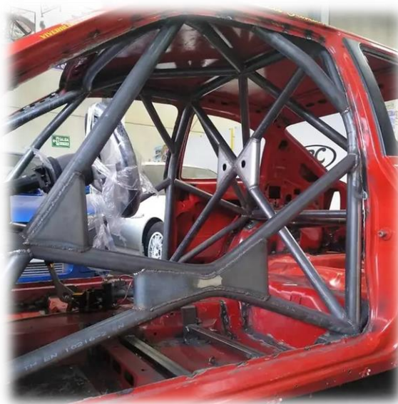
Figura 1. Estructura de seguridad
