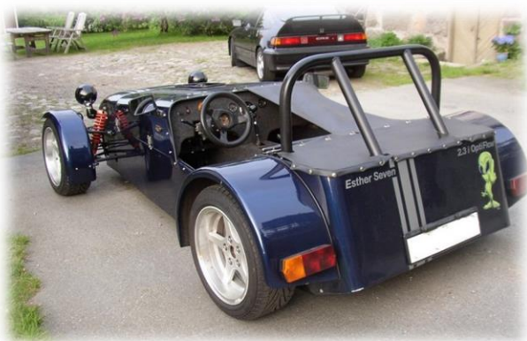
Figura 3. Estructura externa antivuelco.
