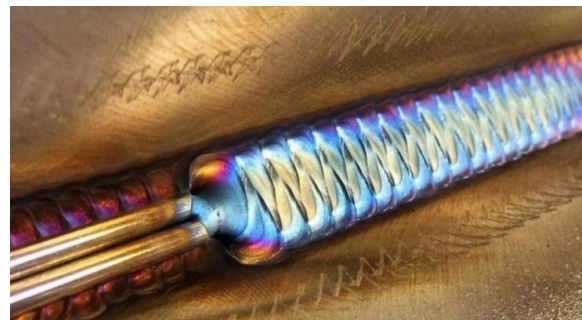
Figura 74. Apariencia exterior soldadura TIG.
