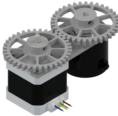
Figura 3.5: Acople y engranajes para el motor paso a paso y el encoder.
