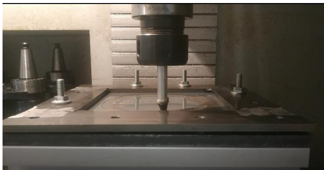
Ilustración 27. Fijación lámina mediante tornillos.
