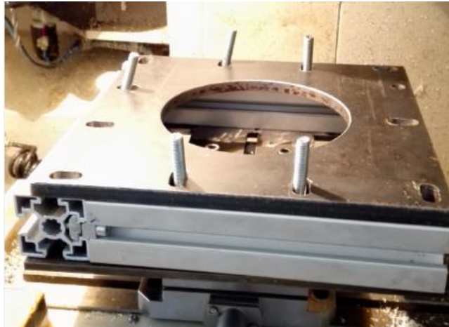
Ilustración 26. Orificio base intercambiable donde tomar el origen.
