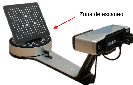
Ilustración 28. Scanner 3D y Matriz calibración.
