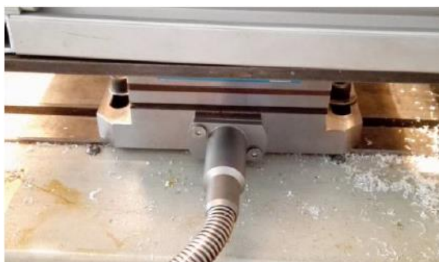
Ilustración 24. Mesa dinamométrica fijada a la base del centro de mecanizado.
