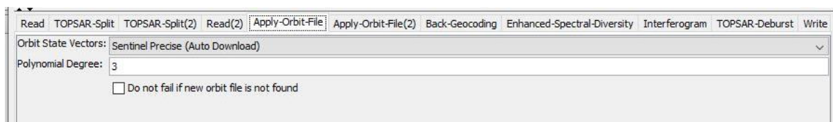
Figura 3.8. Definición de parámetros para la aplicación de órbita precisa en el Graph Builder de SNAP.
