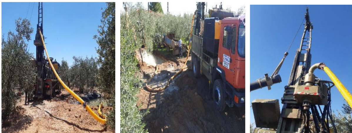
Figura 13. Perforadora Auperminsa JR 803 Polivalente-Sistema de Circulación Inversa.
