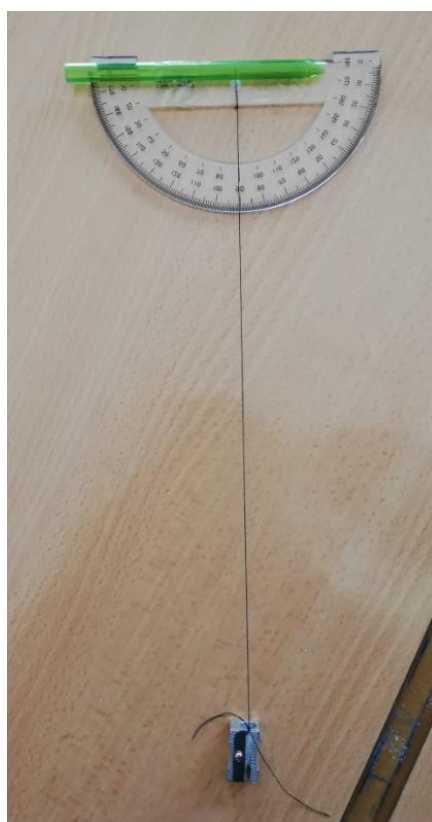
Figura 64. Clinómetro casero para medir ángulos en la actividad fuera del aula
