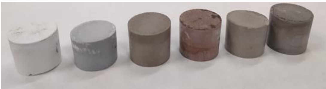
Figura 14. Muestras desmoldadas: MK; MK-CFA; MK-CFA-AA; MK-CFA-AR; MK-CFA-AB y MK-CFA-AN.
