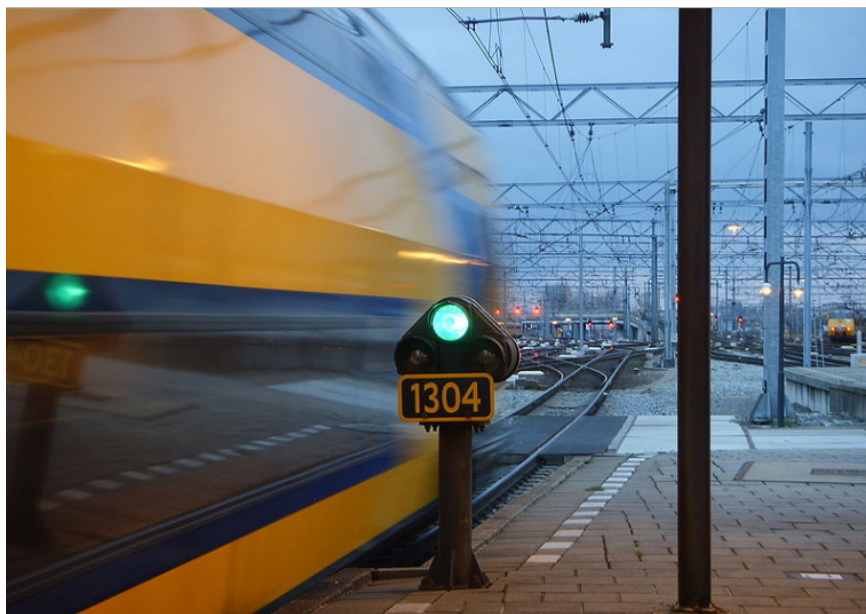
Figura 5: Señal de tipo bajo instalada a nivel del suelo
