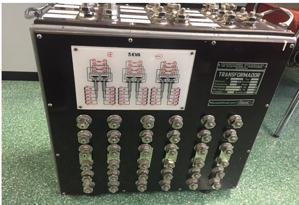
Figura 4.6.2. Transformador trifásico de 5KVA con dos bobinas por devanado.
