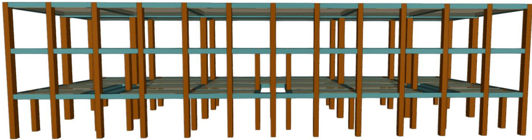
Figura 34. Alzado modelo estructural 3D CypeCad
