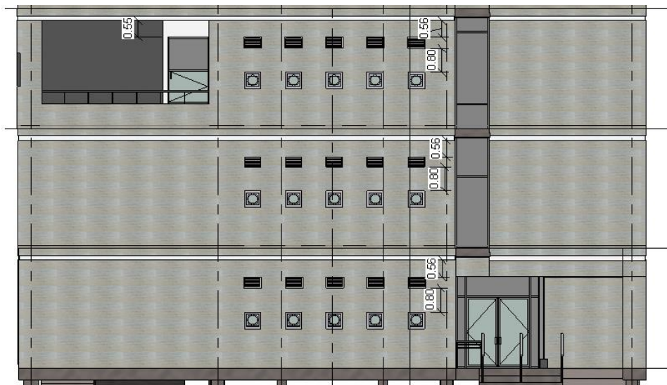
Figura 90. Distribución de ventanas lado Este.
