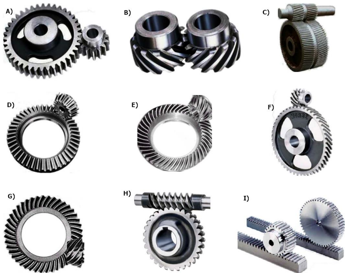
FIGURA 6: Tipos de engranajes según forma de dientes. A) Cilíndricos rectos, B) Cilíndricos helicoidales, C) Dobles helicoidales, D) Cónicos rectos, E) Cónicos helicoidales, F) Helicoidales cruzados, G) Cónicos hipoides, H) tornillo sin fin, I) Piñón/cremallera. [8]
