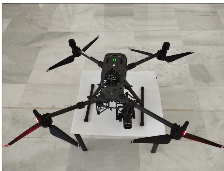
Figura 6 Matrice 300 RTK equipada con la cámara Zenmuse P1.
