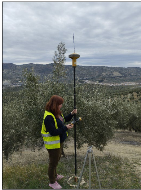
Figura 14 Obtención de las coordenadas para la estación de referencia D-RTK2 de DJI.
