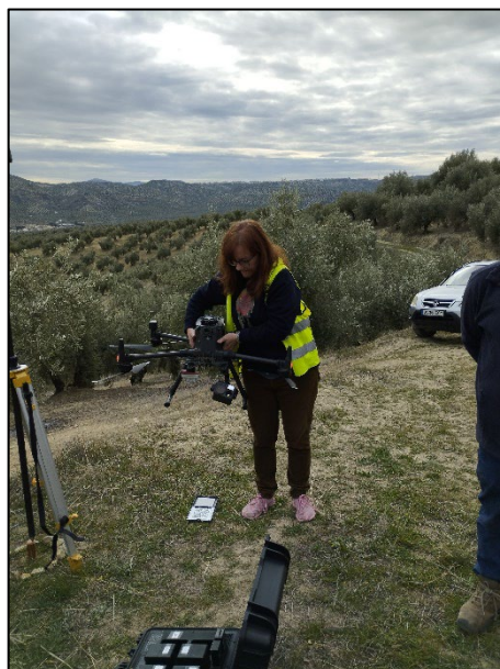
Figura 17 Calibración de la cámara multiespectral Micasense RedEdge.
