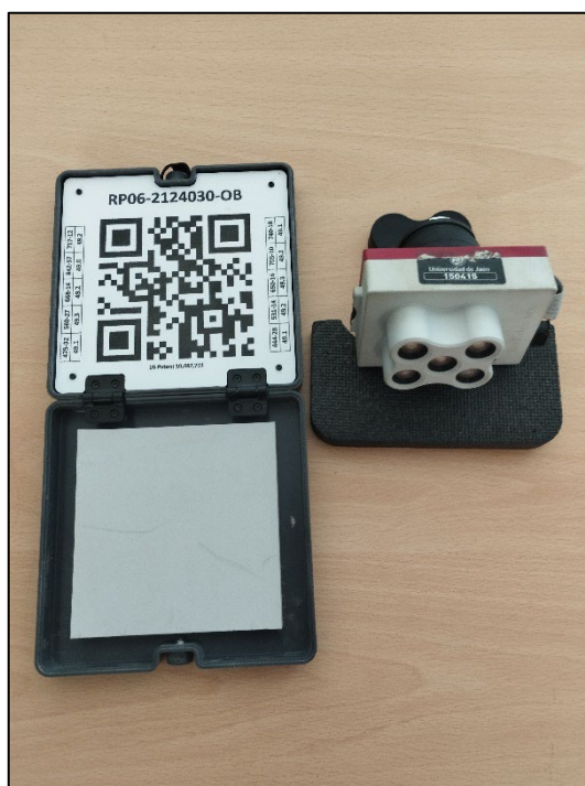
Figura 10 Cámara Micasense RedEdge y su correspondiente placa de calibración
