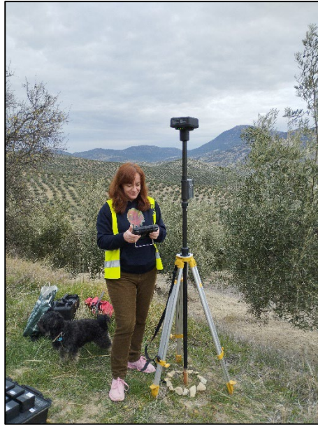
Figura 15 Estación de referencia D-RTK2 de DJI.
