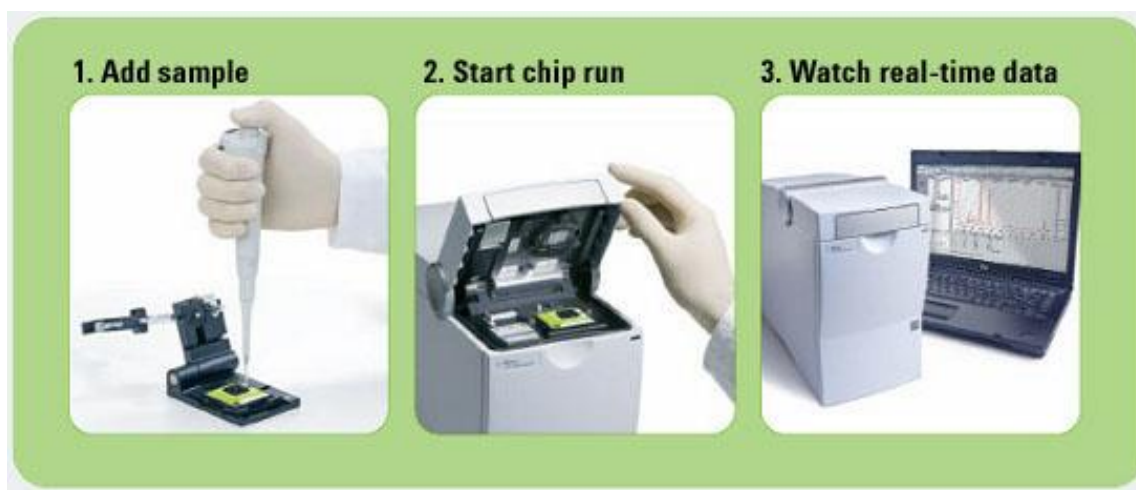
Figura 1. Pasos en la medida de la integridad del ARN mediante el Bioanalizador Agilent 2100.
