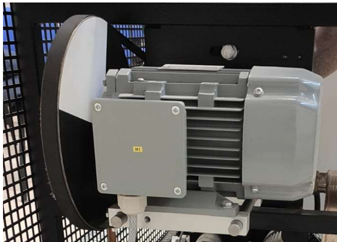
Ilustración 5.3 Generador eléctrico ET-792
