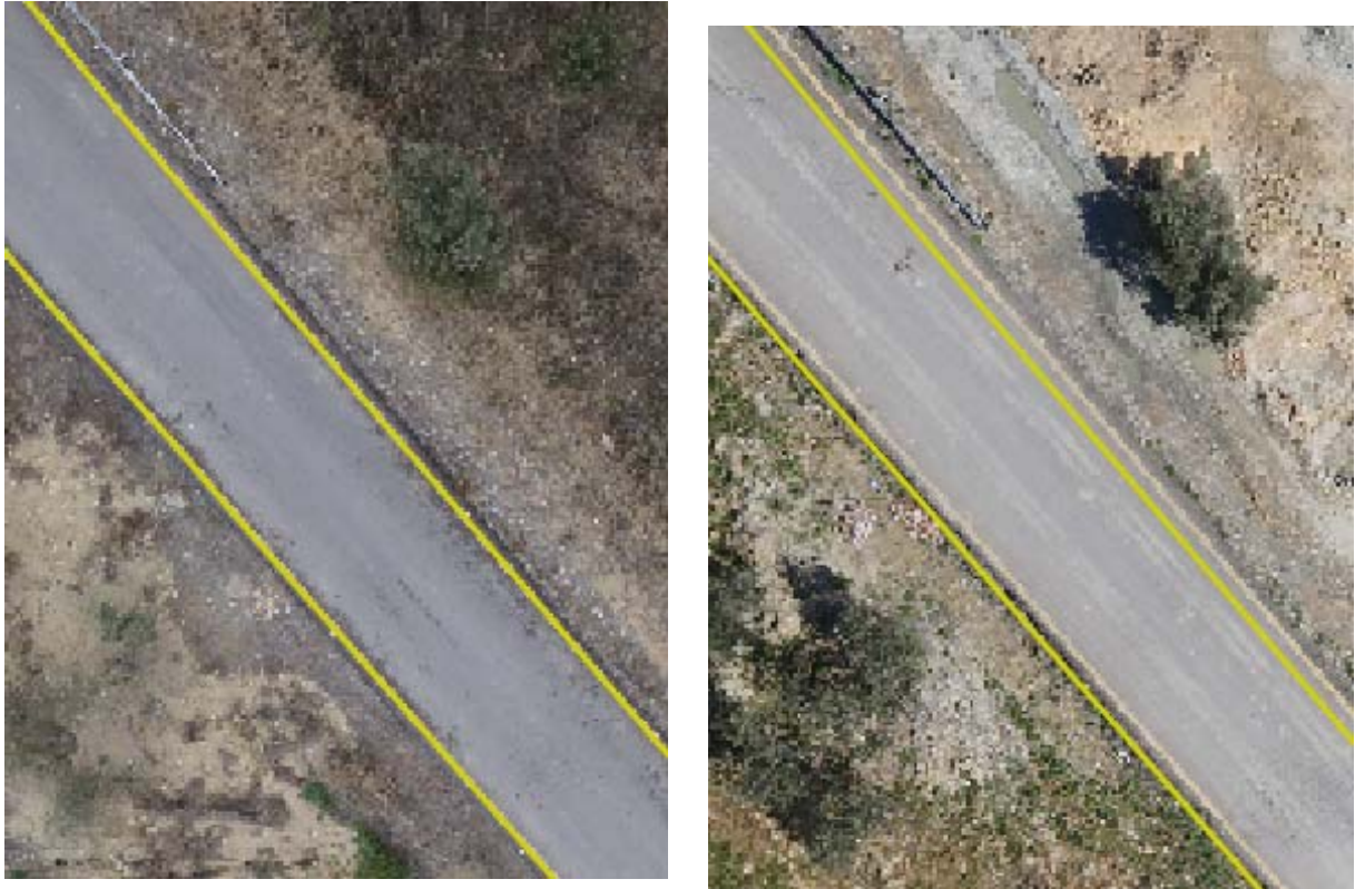
Figura 3.38. Análisis sobre ortofotografías. Ortofotografías pertenecientes a la campaña 20140117 (izquierda) y 20141223 (derecha). Las líneas amarillas corresponden a la campaña 20140117 apreciándose claramente el desplazamiento.
