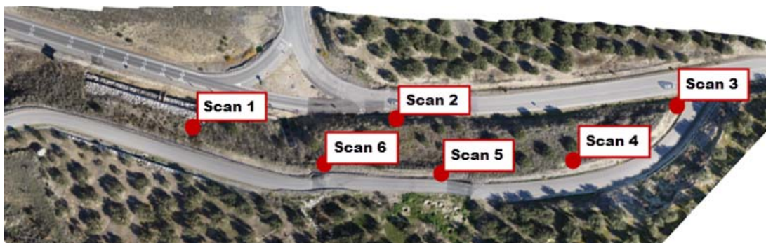
Figura 3.23. Planificación posiciones óptimas del escáner láser.
