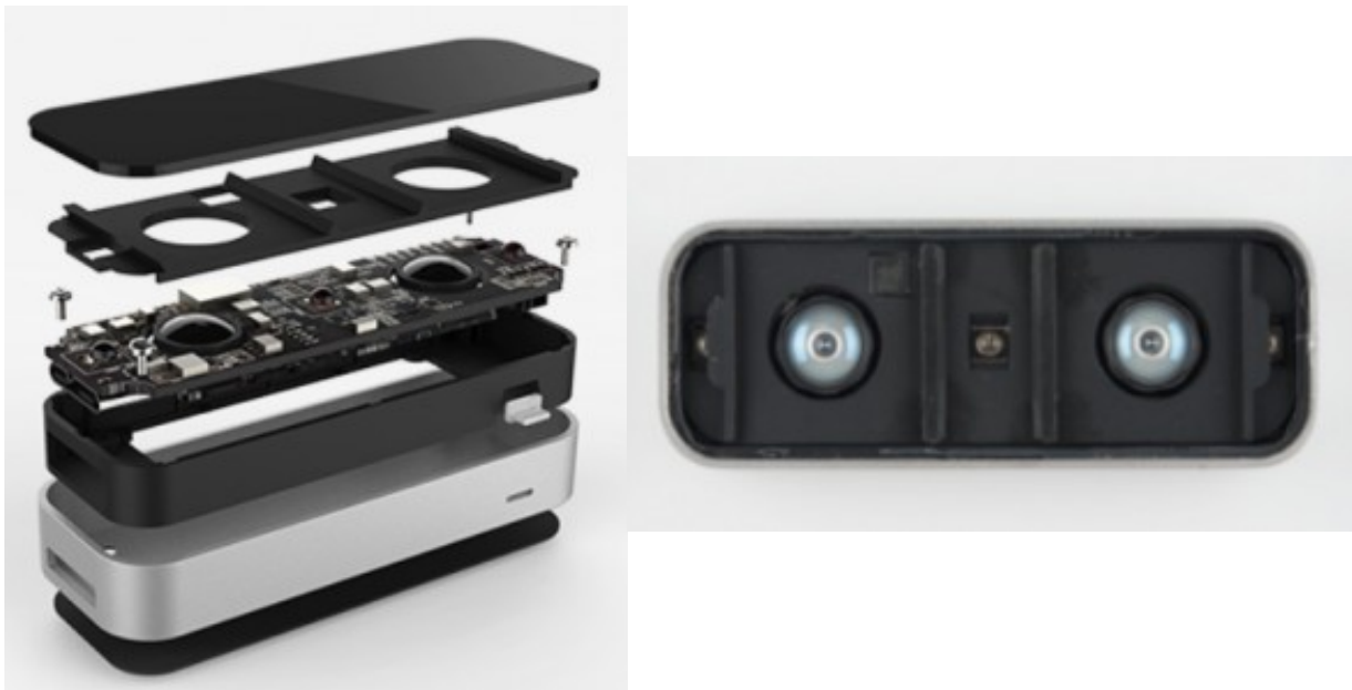
Figura 4.7. Despiece del dispositivo Leap Motion
