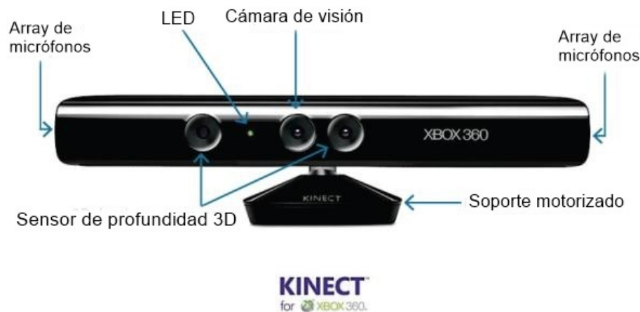
Figura 2.2. Arquitectura del dispositivo Kinect.
