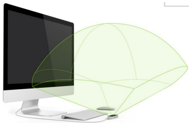
Figura 4.6. Interaction Box creado por Leap Motion
