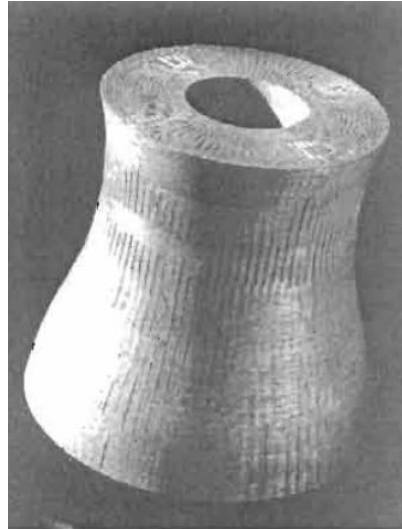
Figura 22. Ejemplo de estructura tridimensional no ortogonal [16]
