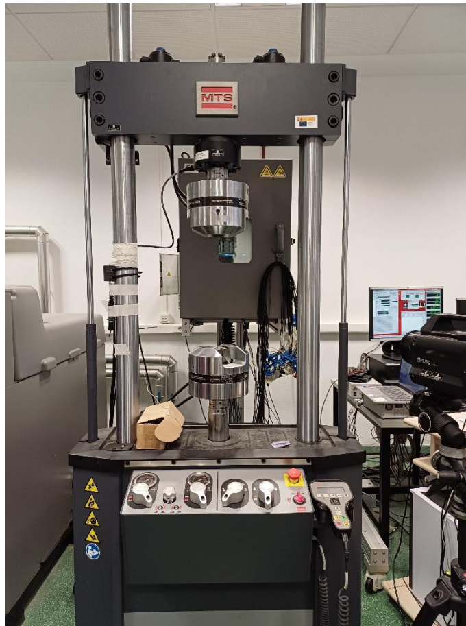
Figura 95. Máquina de tracción hidráulica
