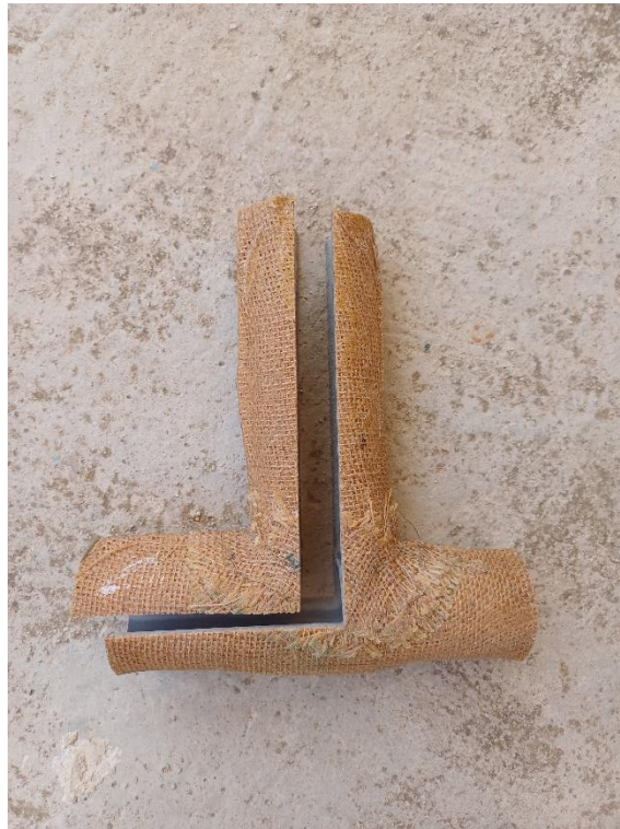
Figura 74. Muestra con stitching seccionada
