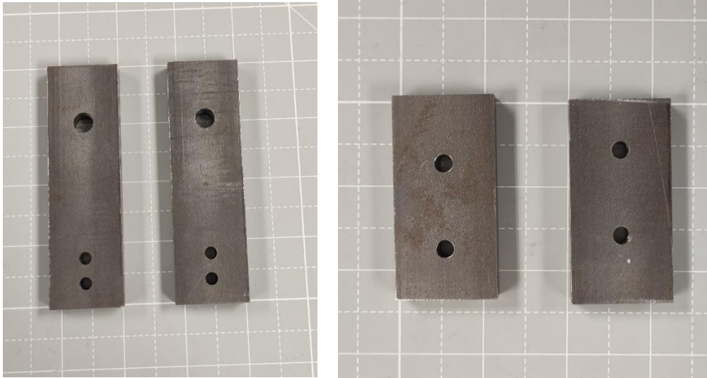
Figura 86. Placa de agarre útil inferior
