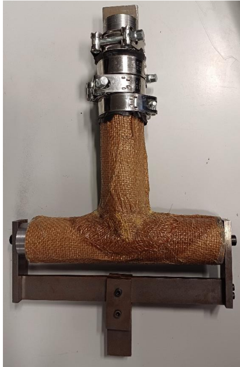
Figura 100. Muestra colocada en el útil con las abrazaderas
