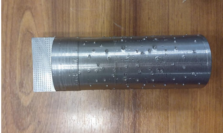
Figura 88. Útil superior con mayor rugosidad
