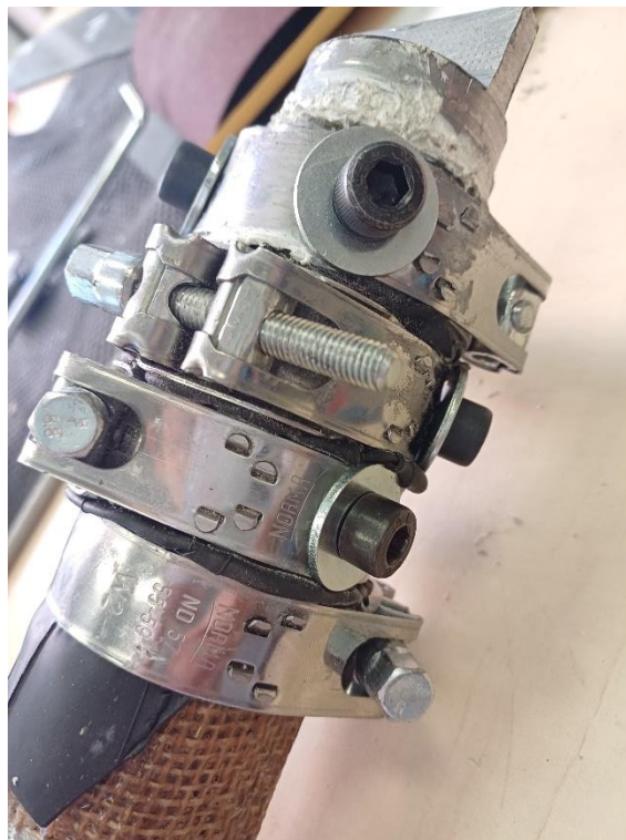
Figura 94. Detalle de las abrazaderas con tornillos
