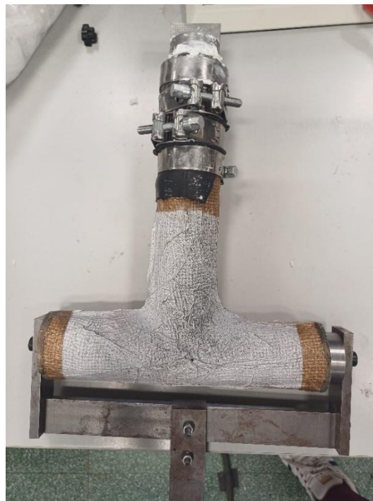
Figura 92. Mejora del sistema de ensayo con adhesivo
