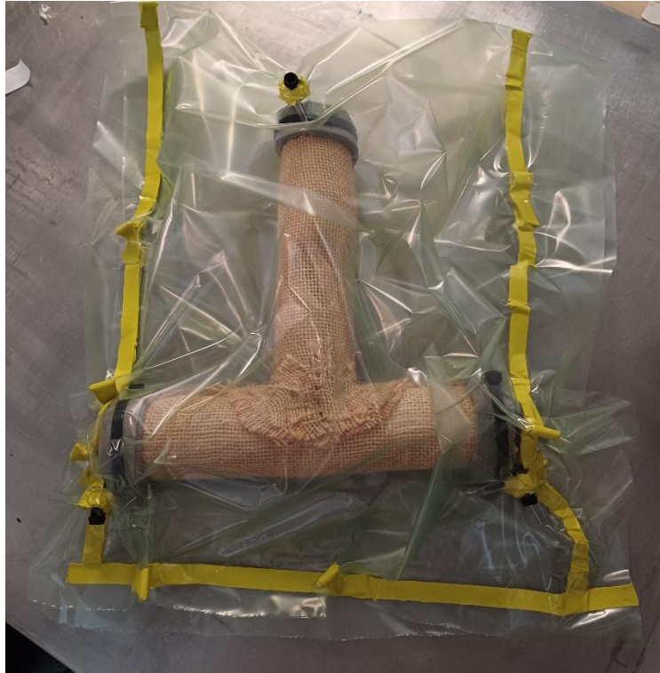
Figura 70. Bolsa de vacío con la muestra
