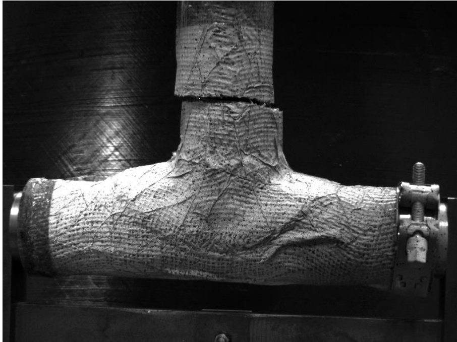
Figura 111. Rotura muestra sin stitching
