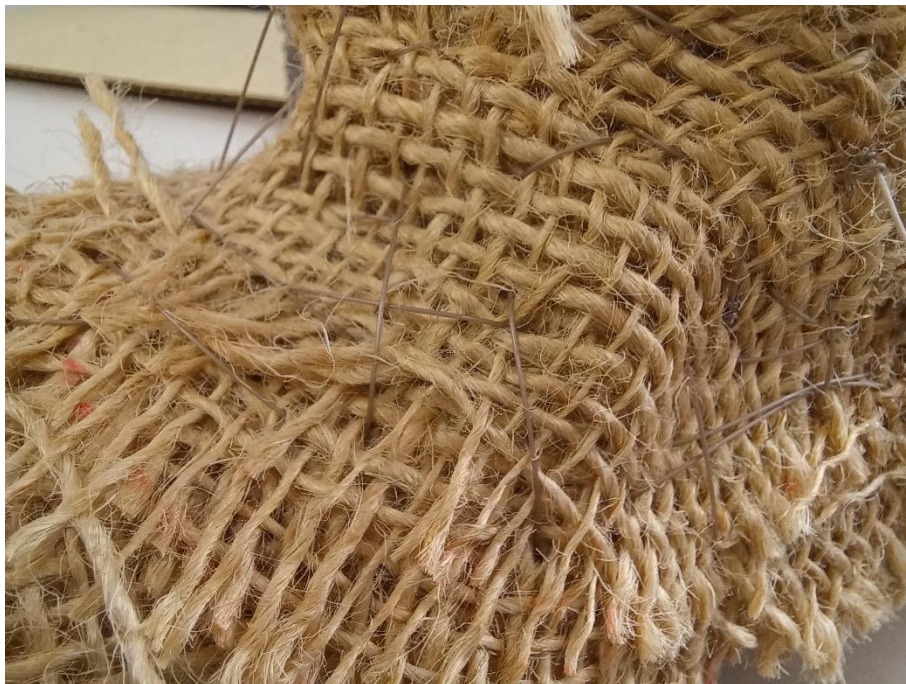
Figura 66. Detalle del cosido de refuerzo
