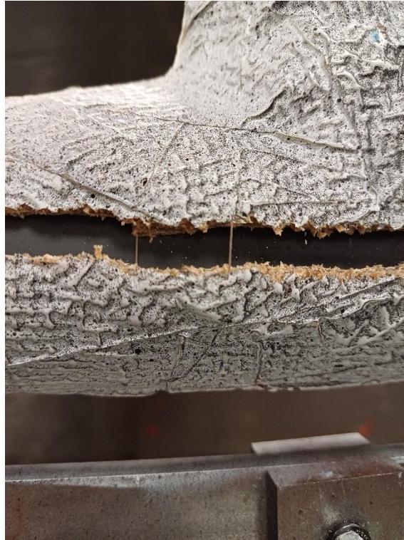
Figura 105. Detalle del stitching tras la rotura
