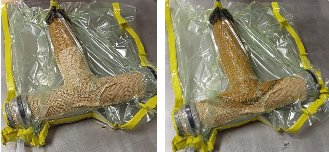
Figura 71. Proceso de infusión
