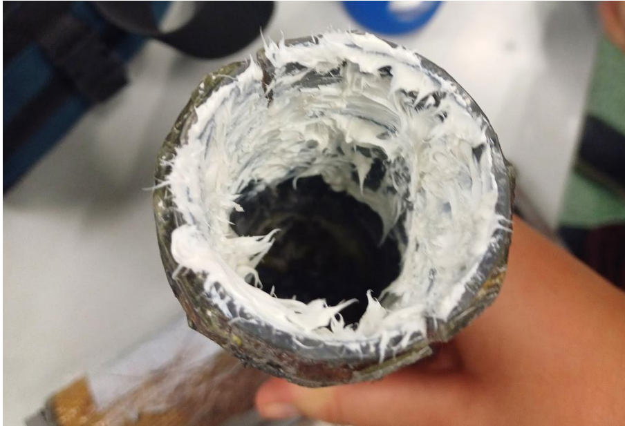
Figura 93. Detalle del adhesivo dentro del tubo
