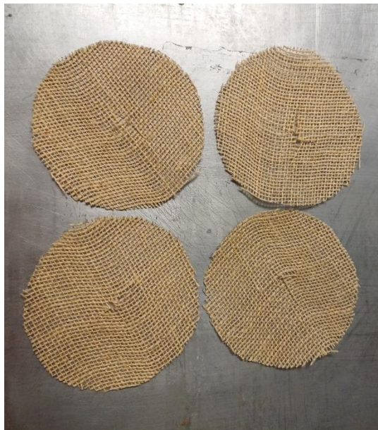
Figura 58. Capas circulares de fibra
