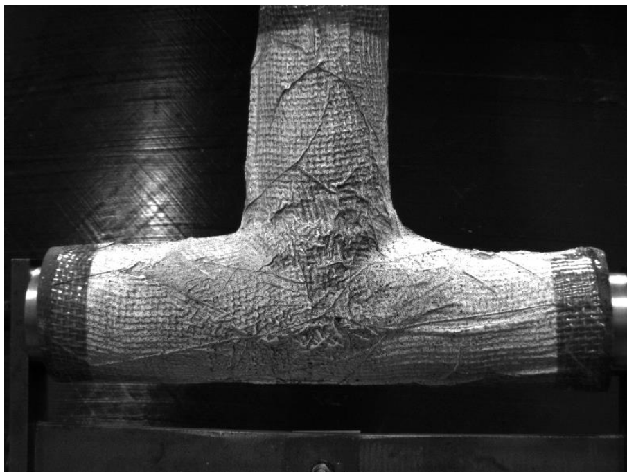
Figura 106. Instante previo a la rotura muestra con stitching
