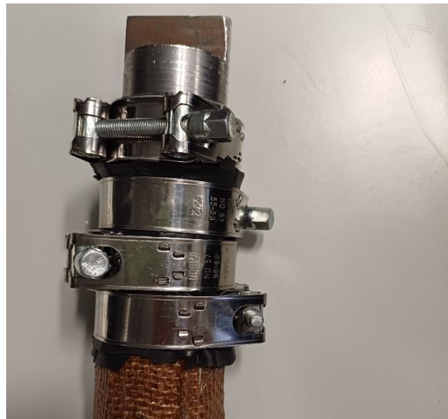
Figura 101. Detalle del agarre con las abrazaderas
