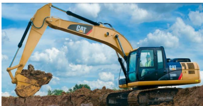
Figura 48: Excavadora hidráulica 320 D2.
