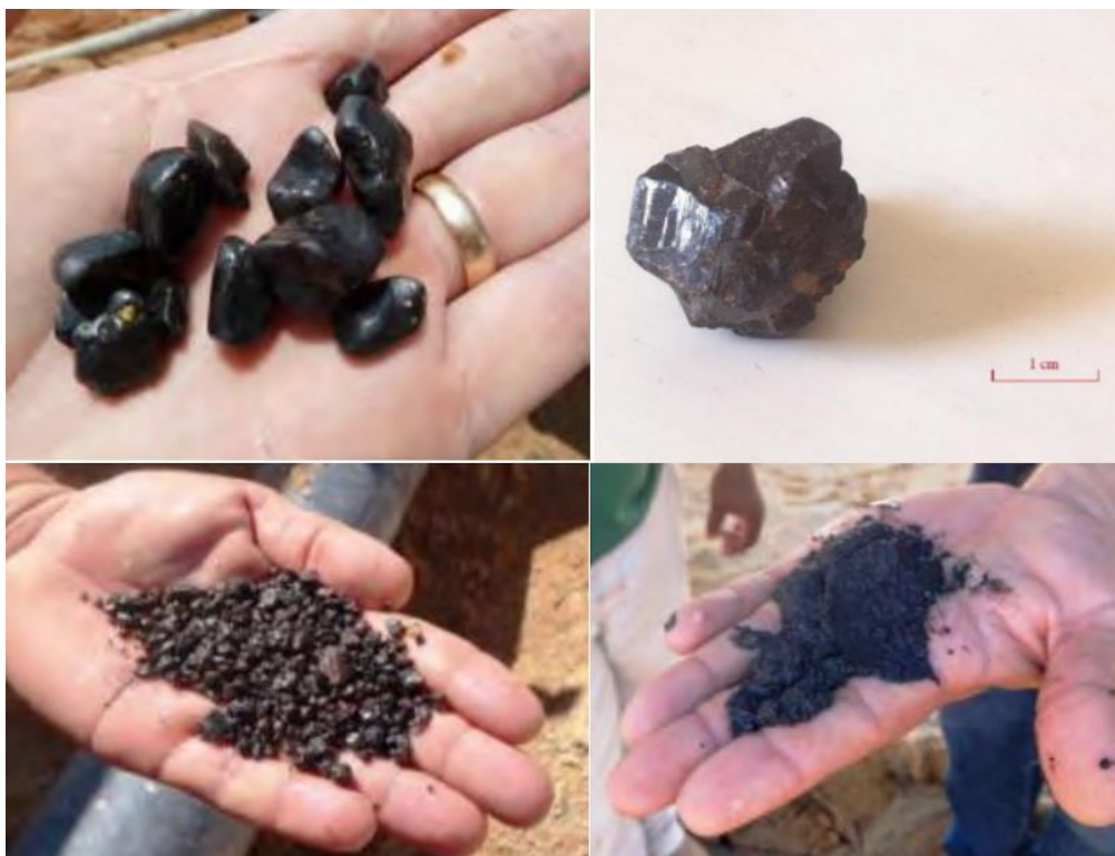
Figura 30: Tamaños granulométricos de casiterita encontrados en la mina.
