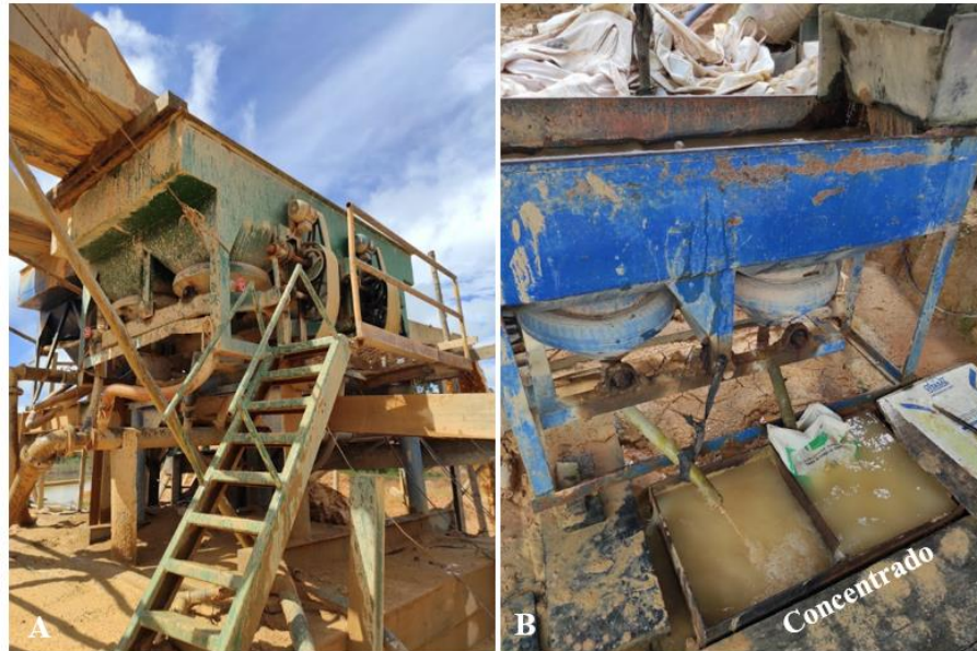
Figura 43: (A) Jig primario de seis celdas. (B) jig secundario de dos celdas.
