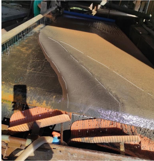
Figura 44: Separación de los minerales en la mesa Wilfley de la empresa.
