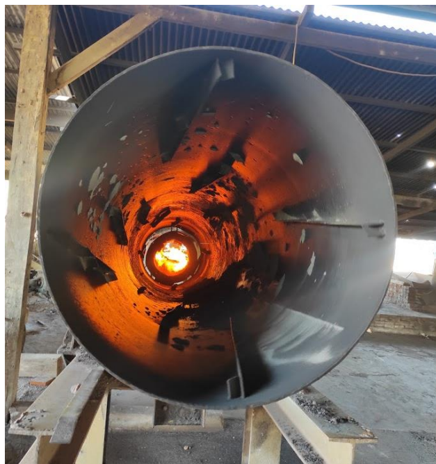
Figura 45: Horno rotativo empleado en el secado del concentrado.
