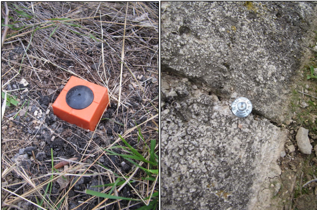
Imagen 3. 3. Materialización de las bases de replanteo
