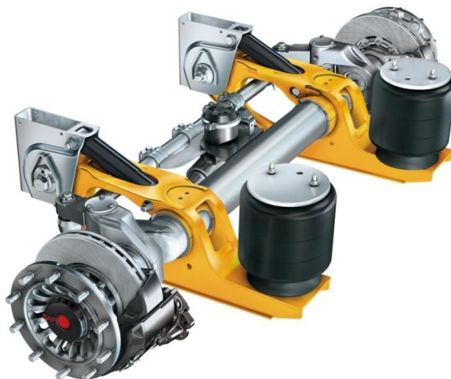
Figura 2.18 Eje auto-direccional SAF modelo BIL9 [21]
