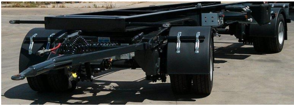
Figura 2.15 Remolque con rueda gemela [19]
