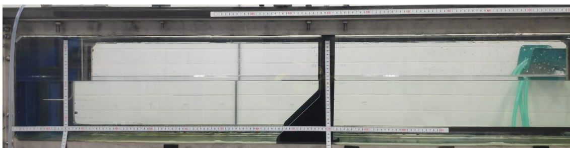
Fotografía 11: Vertedero de pared estrecha de sección Rectangular en Reposo en el canal del laboratorio de la E.P.S.L.
