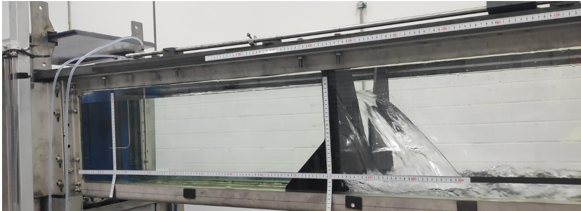
Fotografía 12: Vertedero de pared estrecha de sección Triangular a Frecuencia de bomba de 20Hz en el canal del laboratorio de la E.P.S.L.
