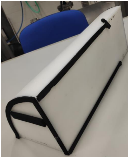
Fotografía 8: Vertedero de pared gruesa de sección rectangular.
