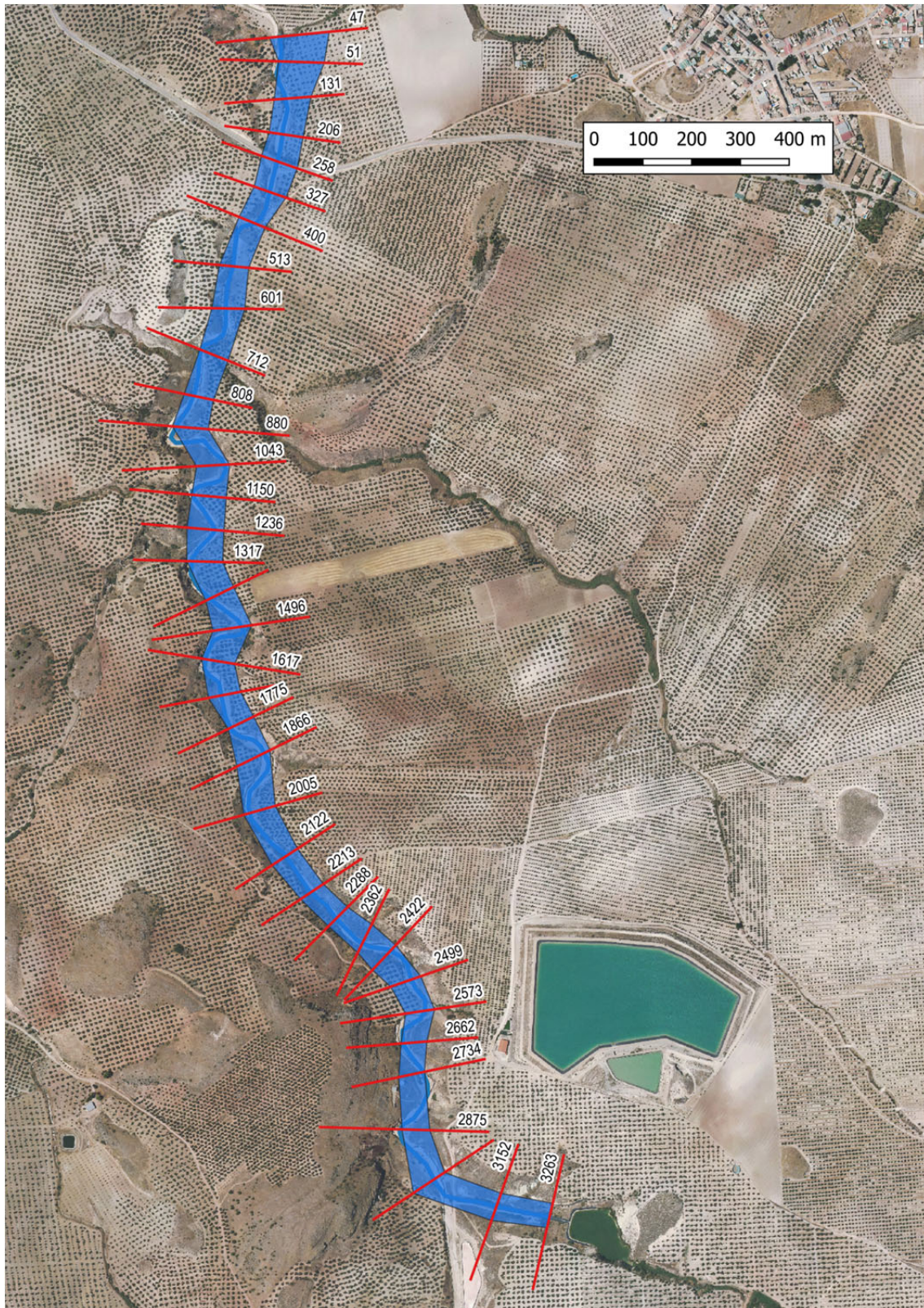
Figura 50. Zona de inundación generada a partir del MDT ALOS
