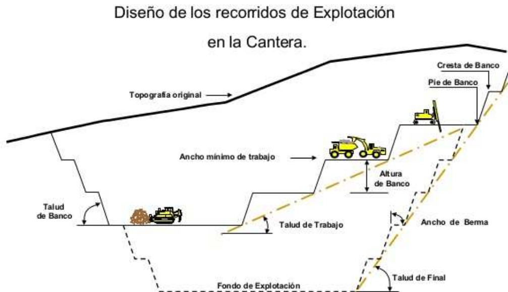
FIG 1.9a. Esquema de trabajo en desmonte descendente.
