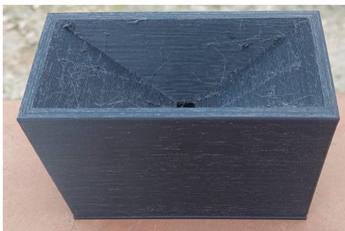
Figura 5.18. Base del pluviómetro
