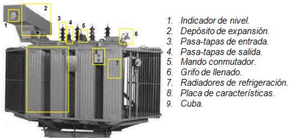
Ilustración 15. Elementos de un Transformador sumergido en aceite
