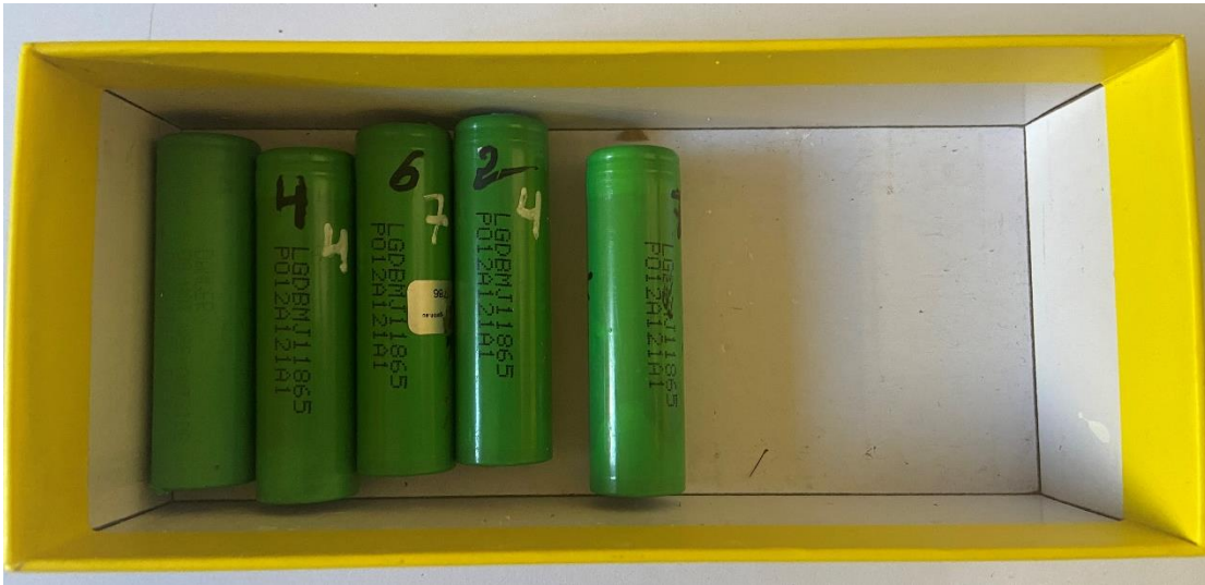
Ilustración 40. Celdas LG DBMJ1 evaluadas y clasificadas.
