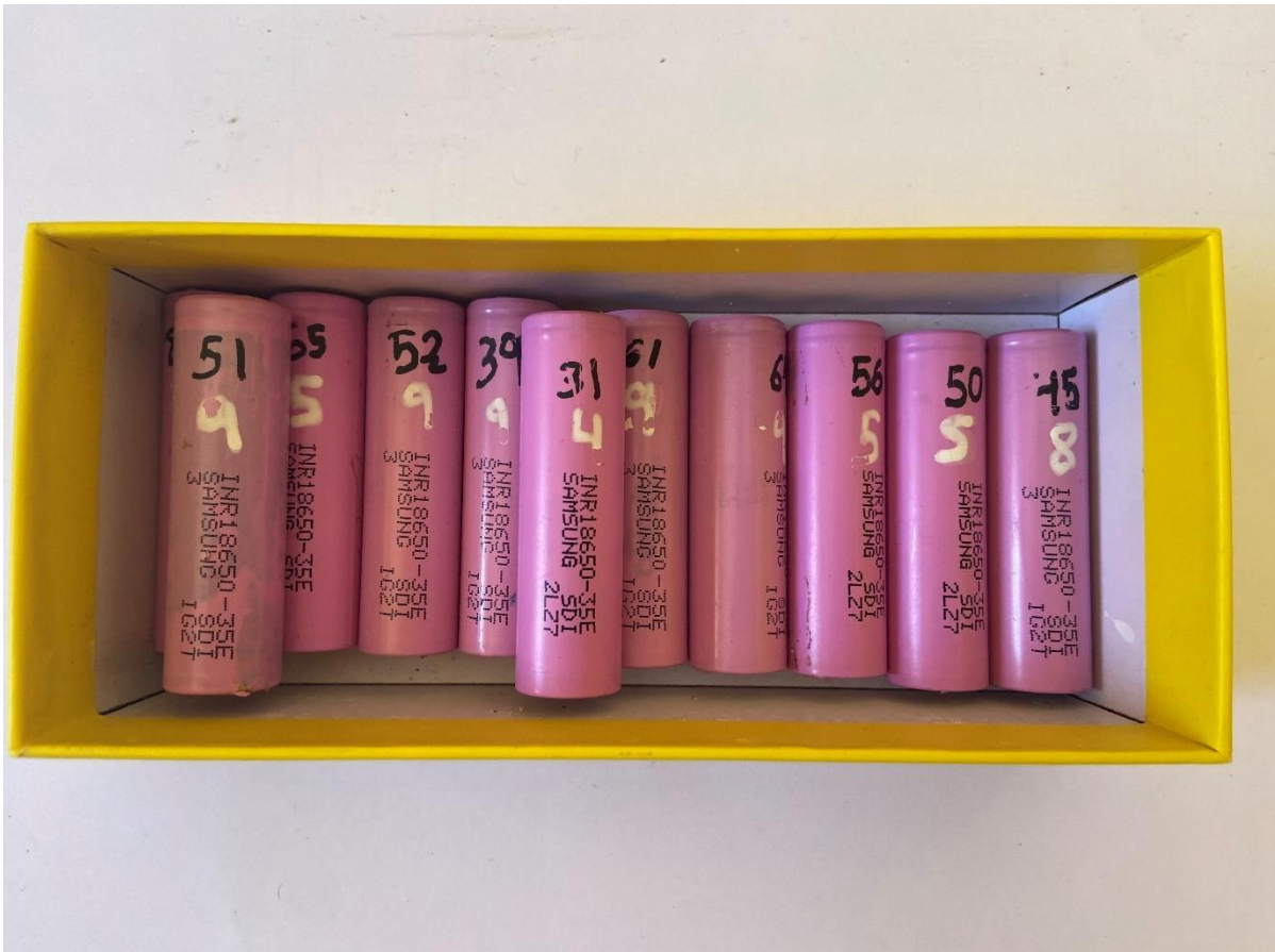
Ilustración 22. Celdas 35E evaluadas y clasificadas.
