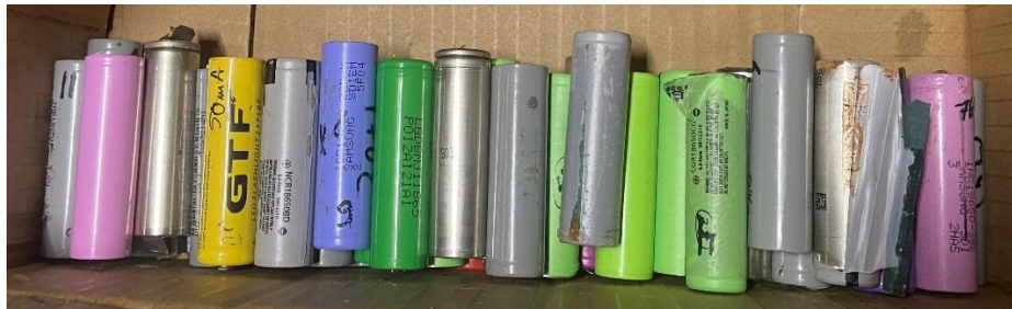
Ilustración 45. Celdas descartadas por aspecto.
