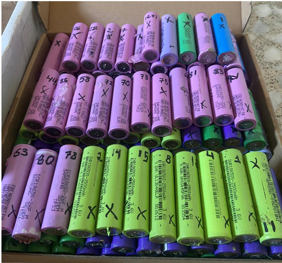
Ilustración 46. Celdas con voltaje por debajo de 2,2 V.
