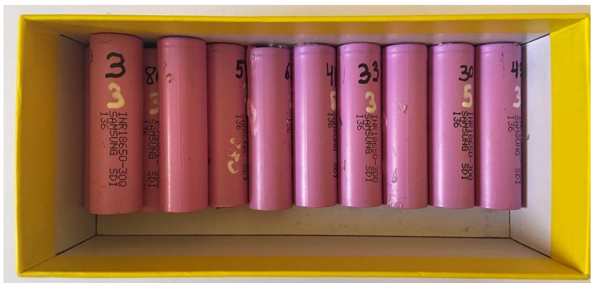
Ilustración 25. Celdas 30Q evaluadas y clasificadas.
