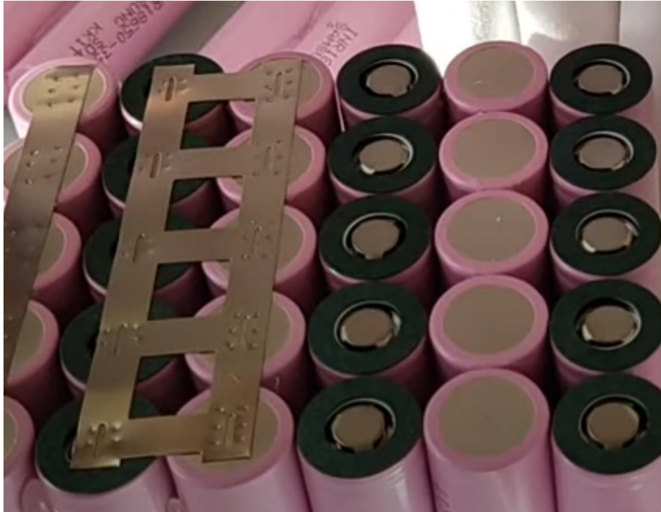
Ilustración 48. Paquete de celdas 18650. 6s5p.
