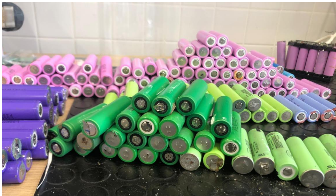
Ilustración 16. Celdas 18650 usadas y desmanteladas.
