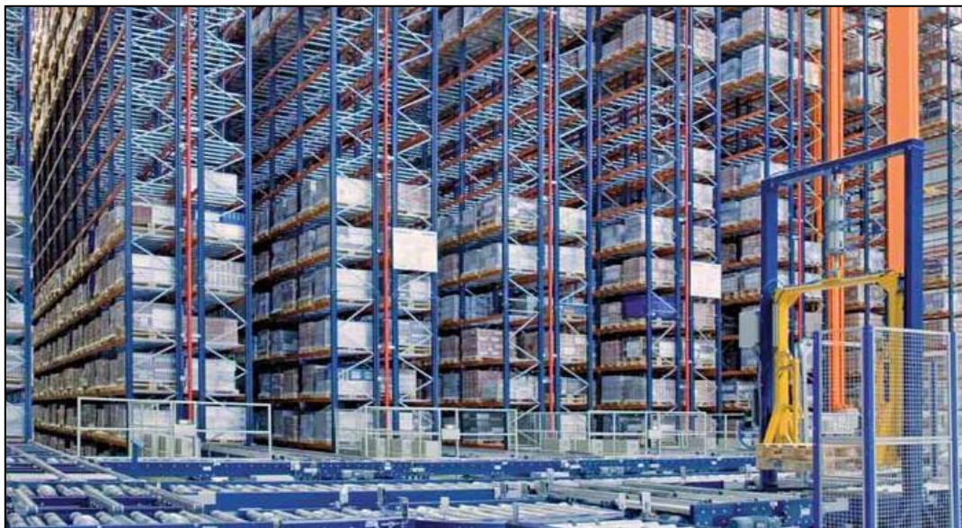
Figura 39: Estanterías de doble profundidad (Mecalux Esmena, s. f.-b)
