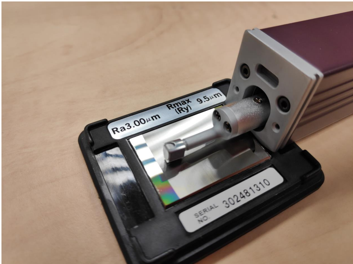
Ilustración 17. Calibración del rugosímetro Surftest SJ-210
