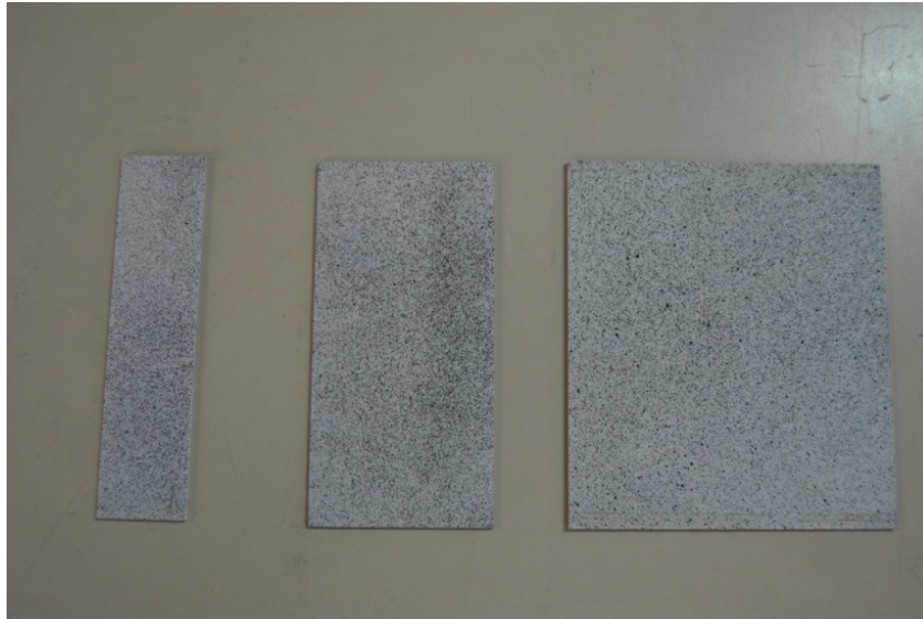
Figura 4.11. Placas fabricadas en CYPLY 1002 de tamaño 150x37.5x2.5, 150x75x2.5 y 150x150x2.5 respectivamente junto a su speckle.
