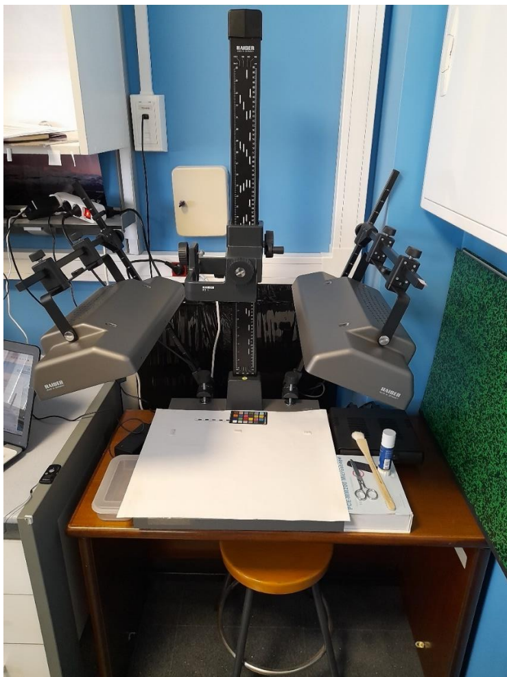
Figura 3.16. Sistema de soporte "Kaiser Sistema R1" KA5511.
