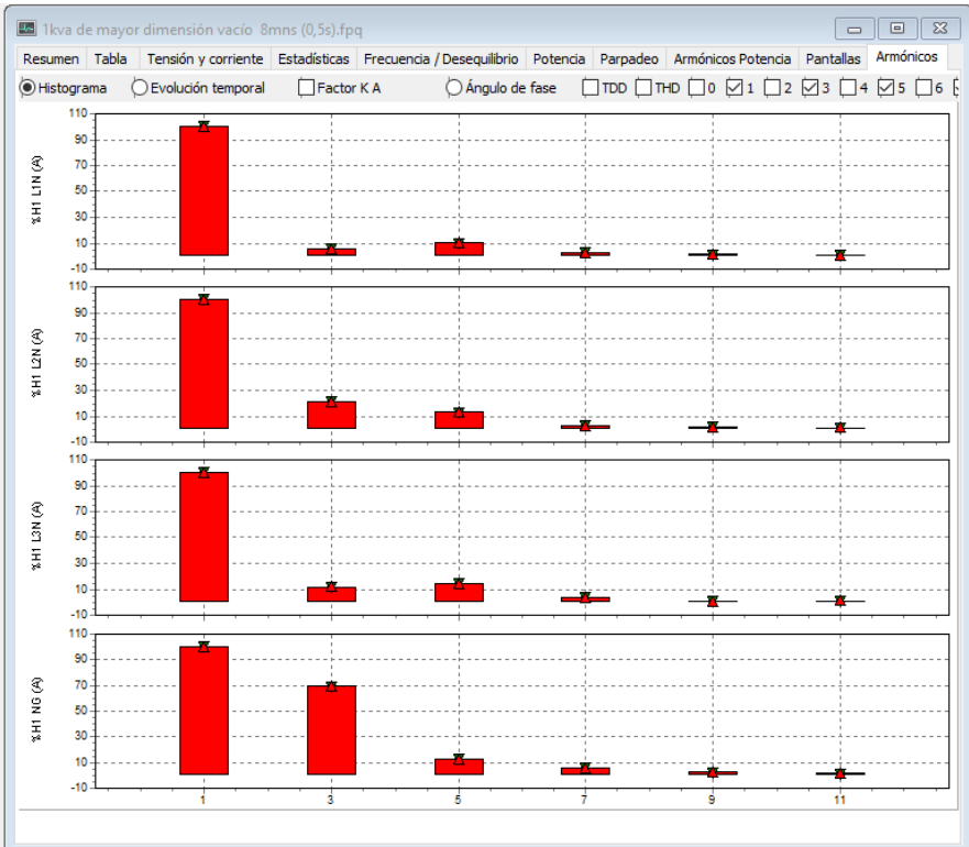
Ilustración 25 Resultados de armónicos de intensidad en vacío del trafo modelo 1 histógrafo.
