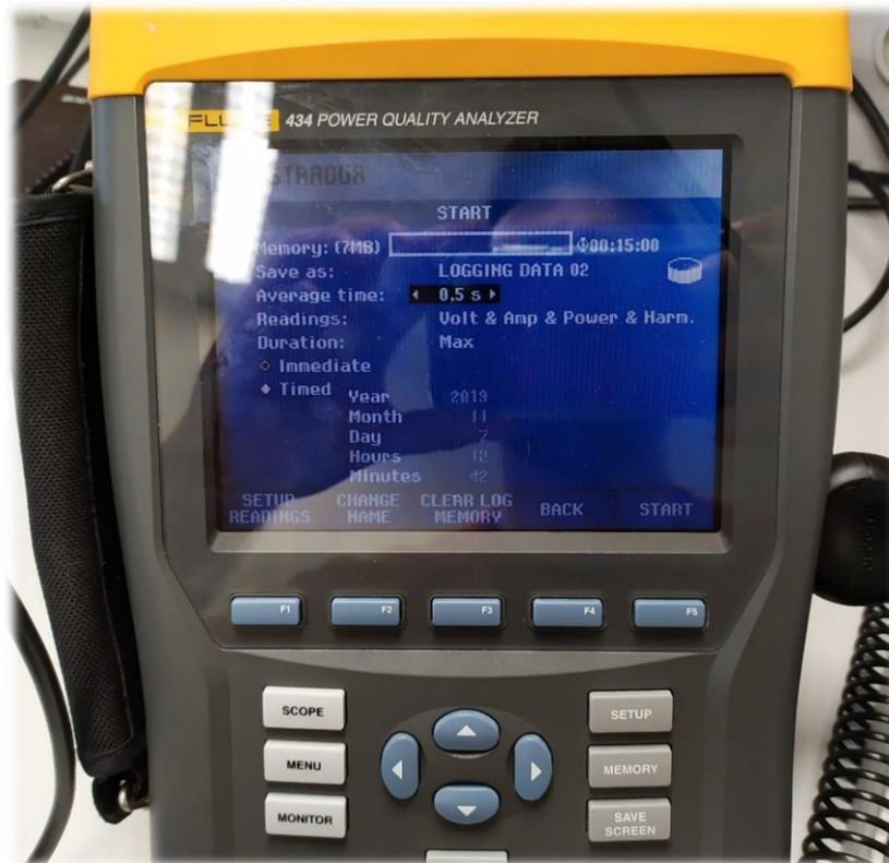
Ilustración 17. Ejemplo de condiciones predeterminadas de lectura en el analizador de redes
