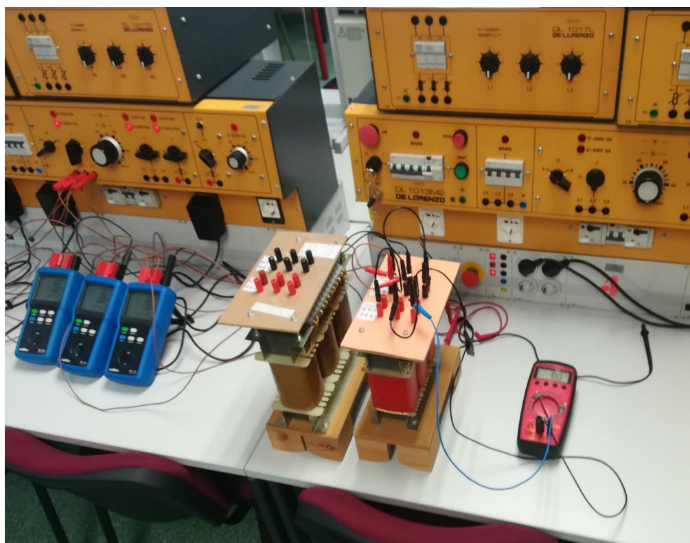
Ilustración 6. Esquema físico de la instalación para el ensayo en vacío del trafo modelo 2(Y-Y).
