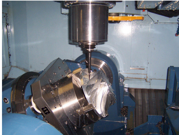
Figura 2.7: fresadora de 5 ejes (www.bhicorporation.com)
