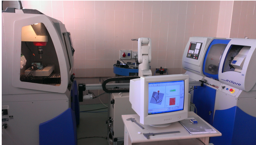
Figura 4.24: Fresadora CNC junto con la simulación en WinUnisoft
