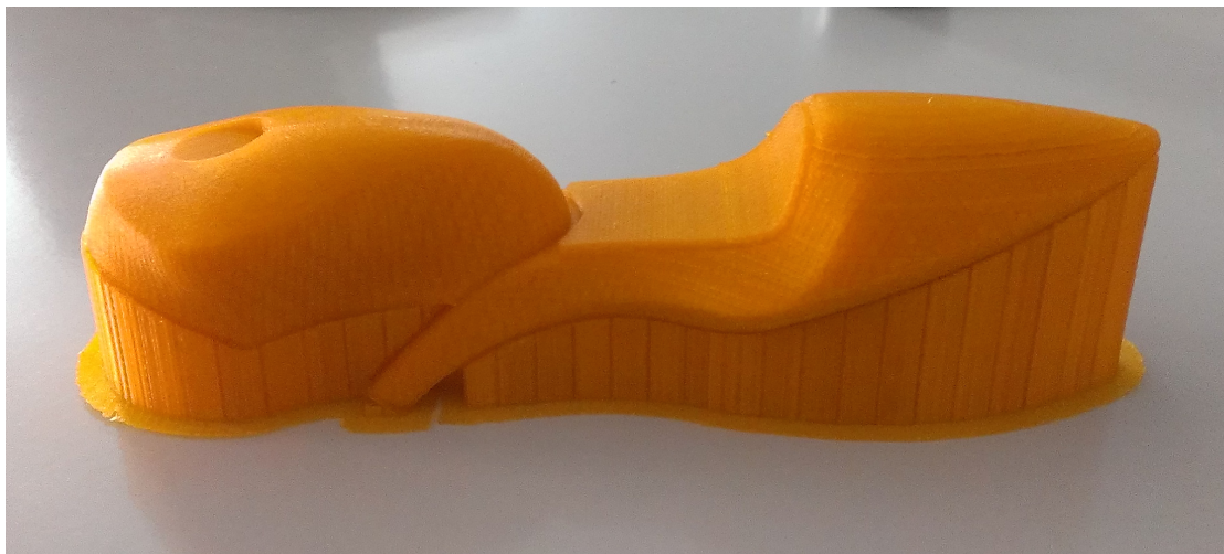
Figura 4.49: Acabado final de la impresión del carenado de depósito y colín
