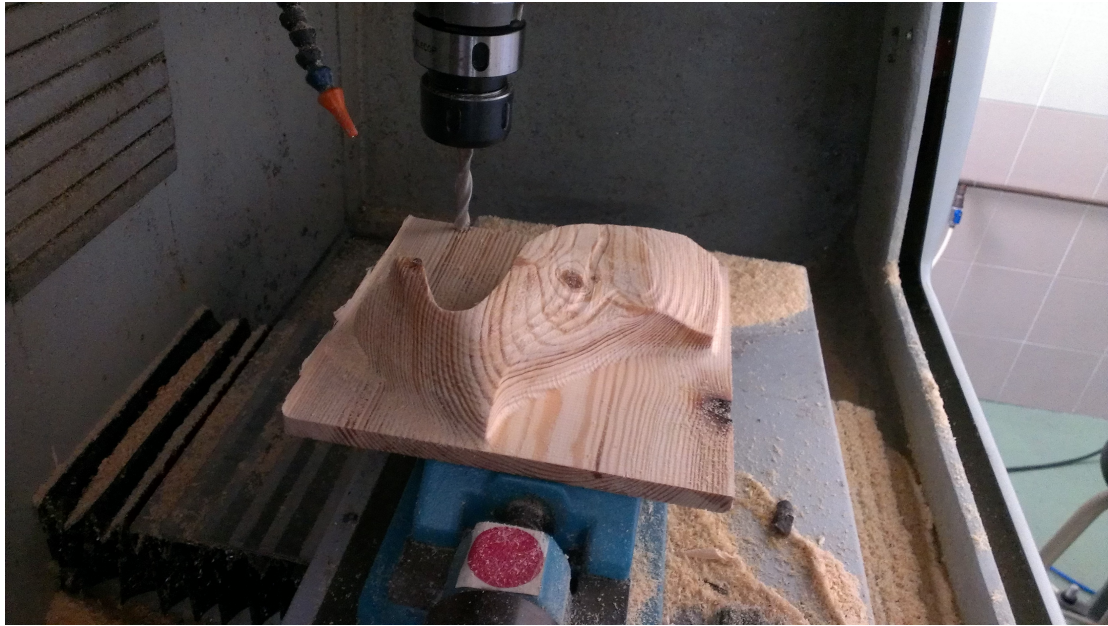
Figura 4.26: Fin del mecanizado del primer molde
