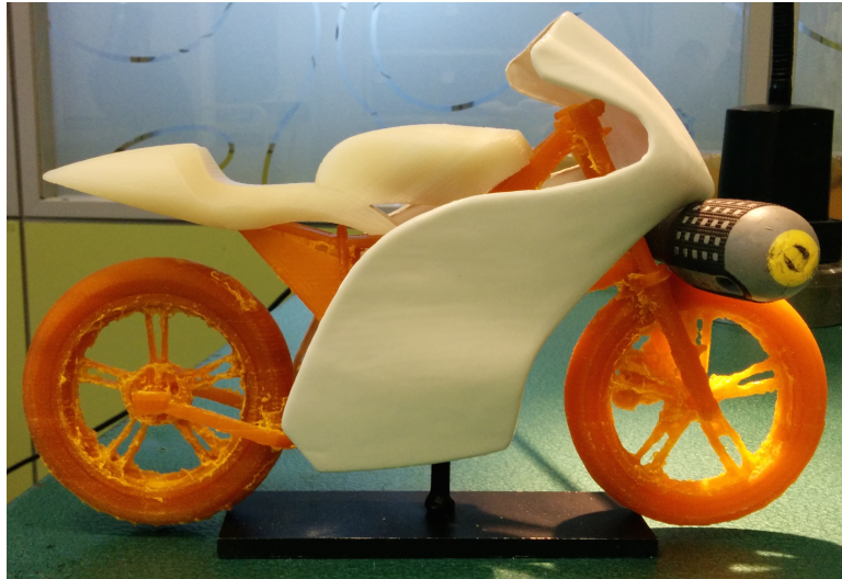
Figura 4.51: Pegado del carenado frontal y del colín
