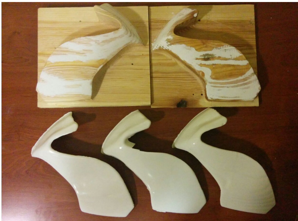
Figura 4.35: Moldes mejorados con masilla cerámica y algunos ejemplos de las piezas obtenidas
