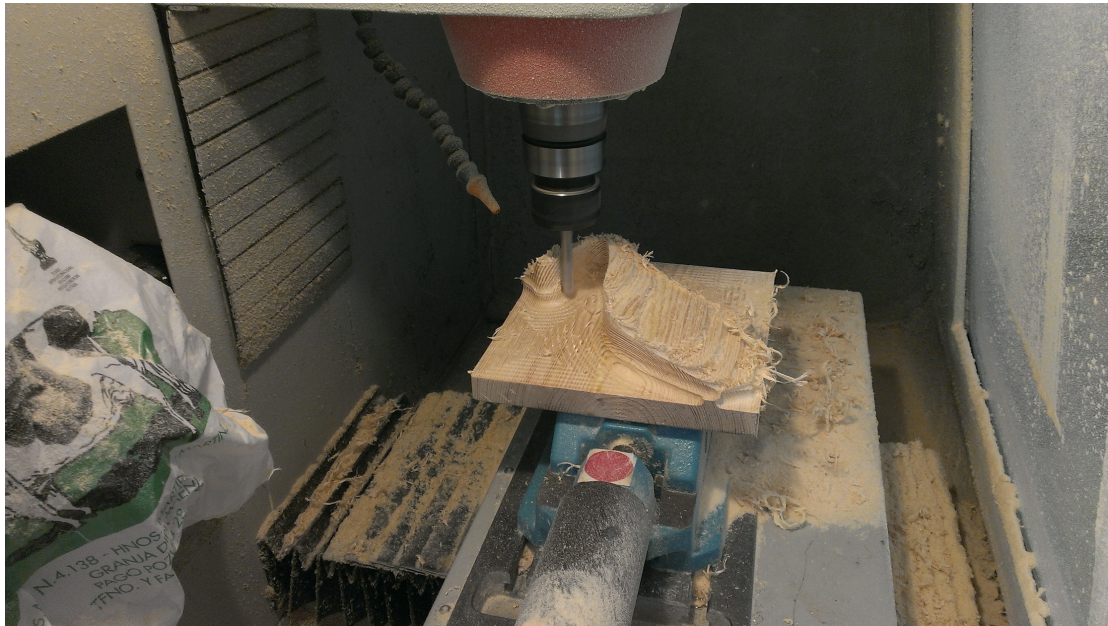
Figura 4.28: Mecanizado del segundo molde con un solape de la herramienta igual al radio
