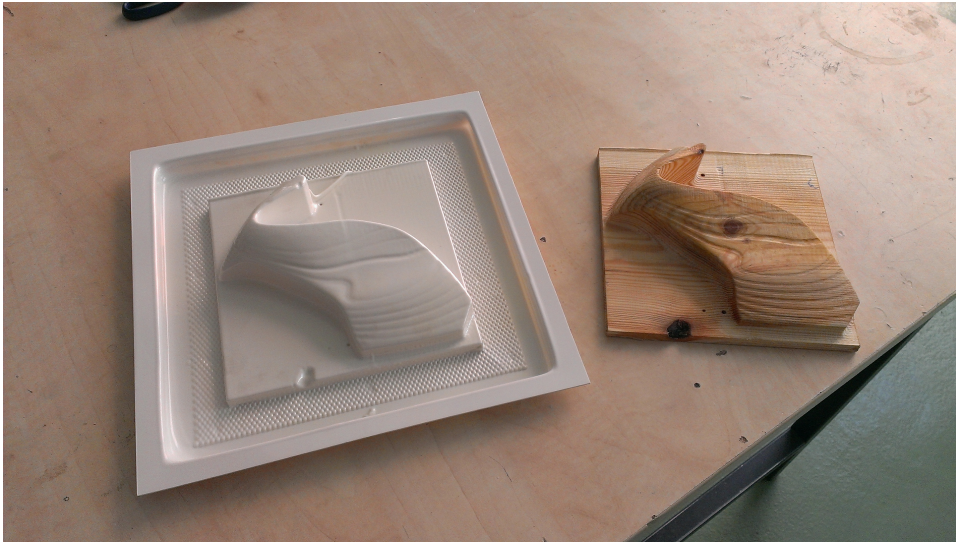
Figura 4.34: Lámina de ABS después del termoconformado
