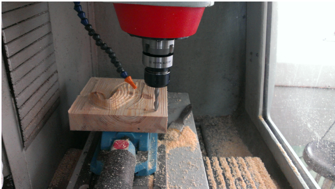
Figura 4.25: Mecanizado del primer molde con un solape de la herramienta de la mitad del radio
