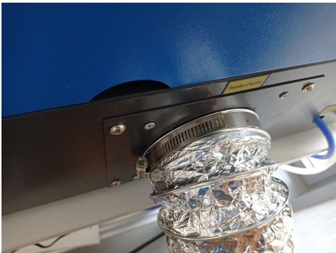
Fig. 49. Ejemplo de instalación del tubo de escape de gases [Imagen propia]
