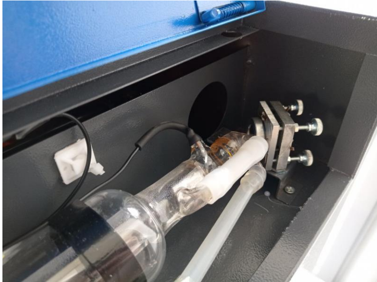
Fig. 26. Primer espejo del sistema óptico [Imagen propia]
