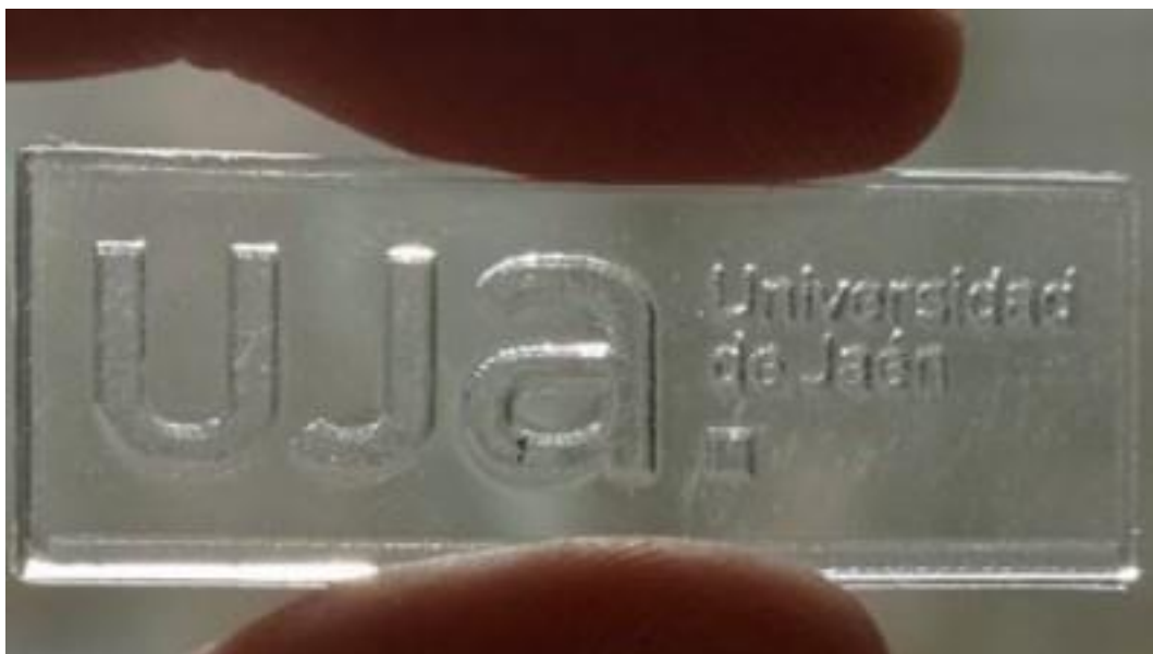
Fig. 81. Ejemplo de grabado en PMMA [Imagen propia]
