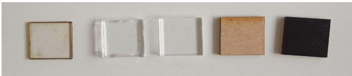
Fig. 84. Diferencias de acabado en los diferentes materiales. (PC, PS, PMMA, MDF, MDF) [Imagen propia]
