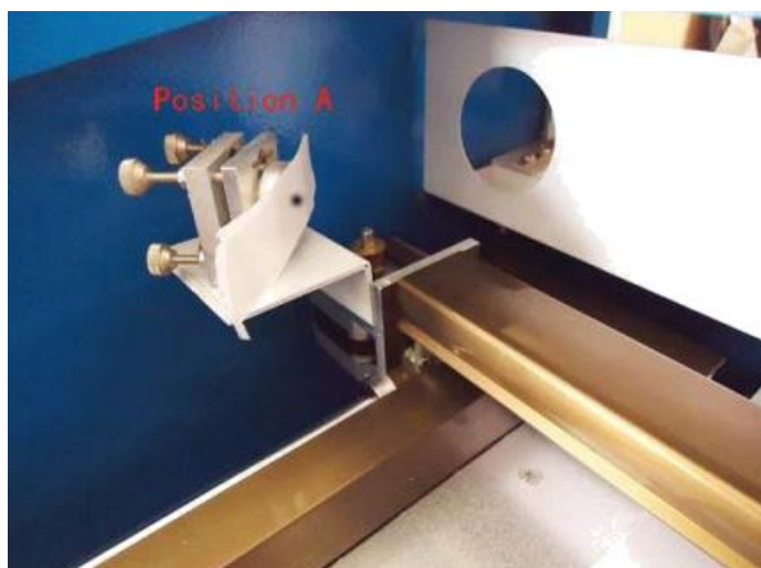
Fig. 62. Espejo 2 en la posición A [Imagen extraída del manual]
