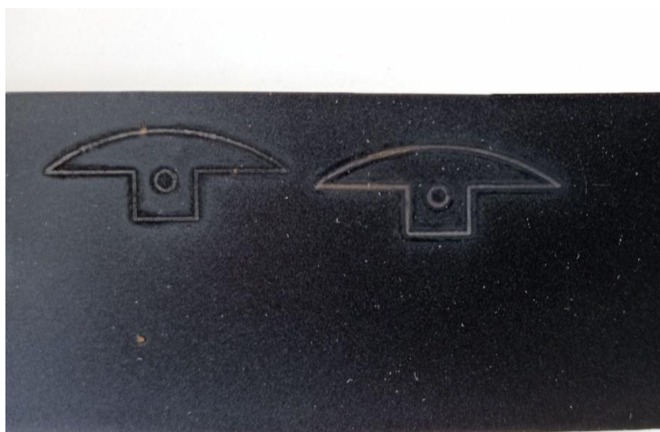
Fig. 80. Intentos de corte fallidos en latón [Imagen propia]
