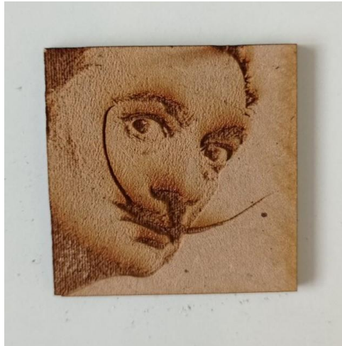
Fig. 82. Ejemplo de grabado en 3D en MDF [Imagen propia]
