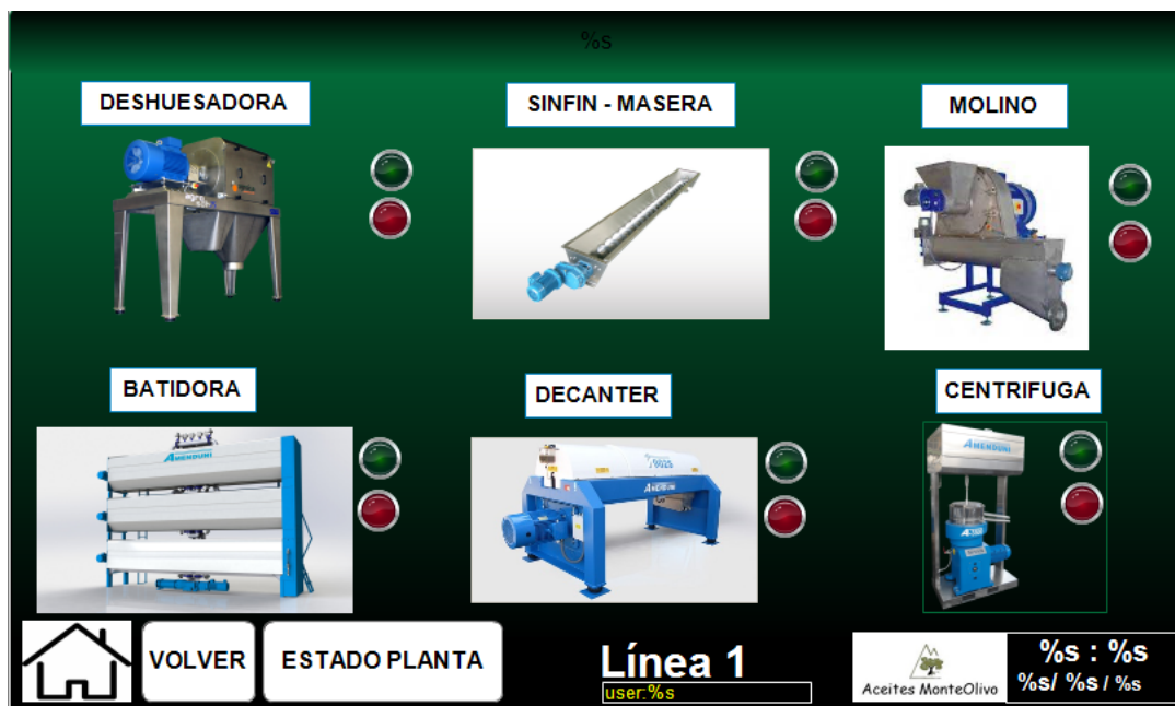
Figura 6.92. Menú principal del Scada.
