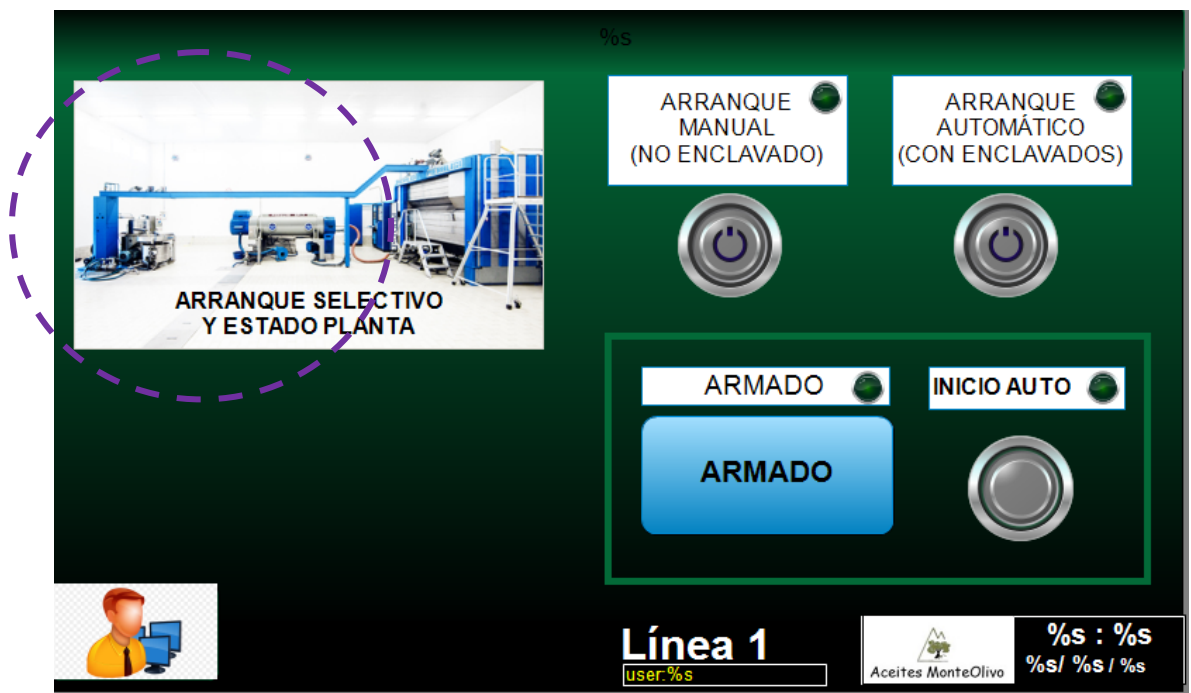
Figura 6.91. Pantalla principal del Scada.
