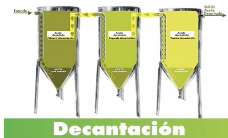
Figura 4.9. El proceso de decantación del aceite.
