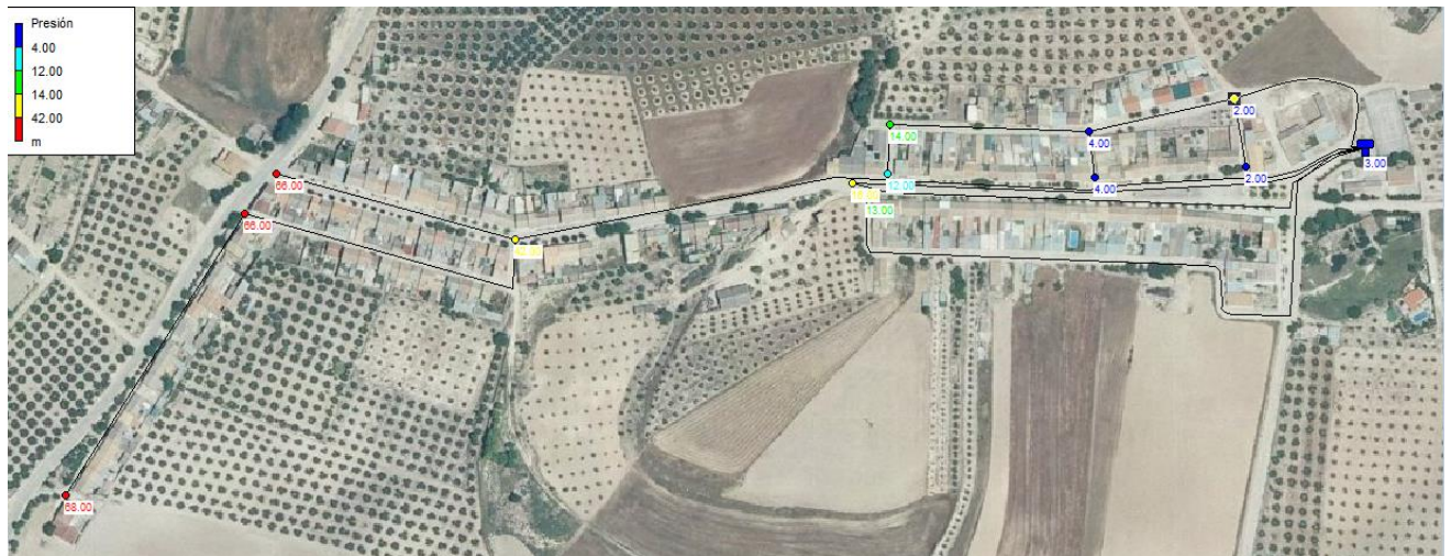
Figura 4.10. Imagen de la red de distribución
