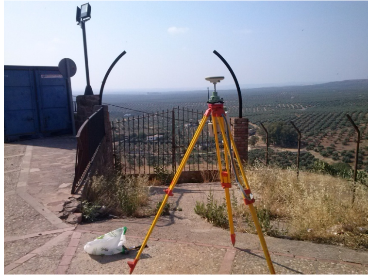
Figura 13 – Equipo GNSS colocado sobre trípode midiendo en post proceso y emitiendo correcciones
