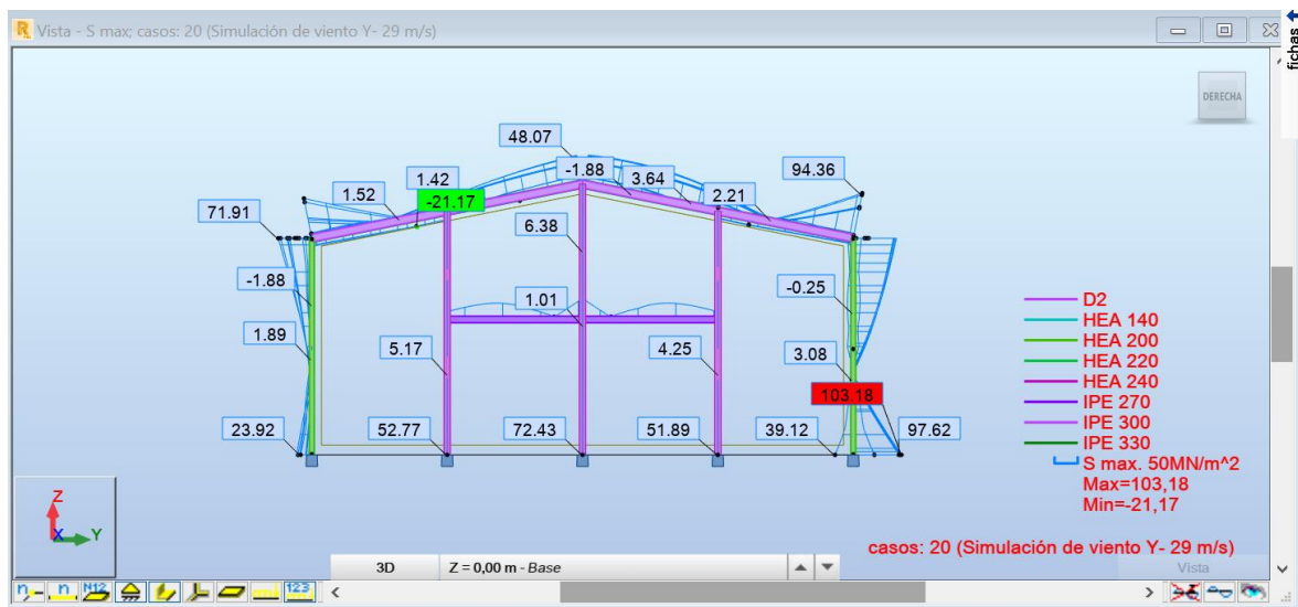
Figura 8.17. Tensiones vista alzado viento simulación Y-
