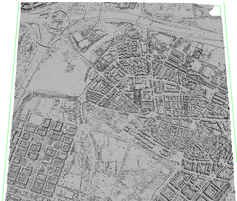
Figura 31. MDS a partir de LIDAR con el uso del software LasTools
