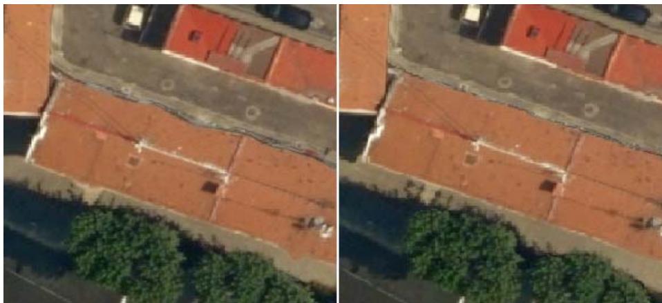
Figura 48. Diferencia entre ortoimágenes generadas con distintos MDS
