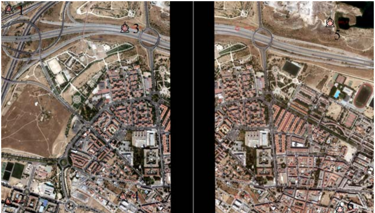
Figura 19. Distribución de los puntos de control (esquinas superior e inferior y zona centro).
