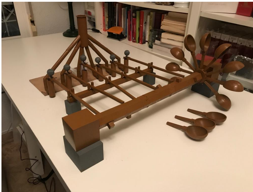
Figura 63: Ensamblaje de la bomba de seis cilindros de Taqī ad-Dīn
