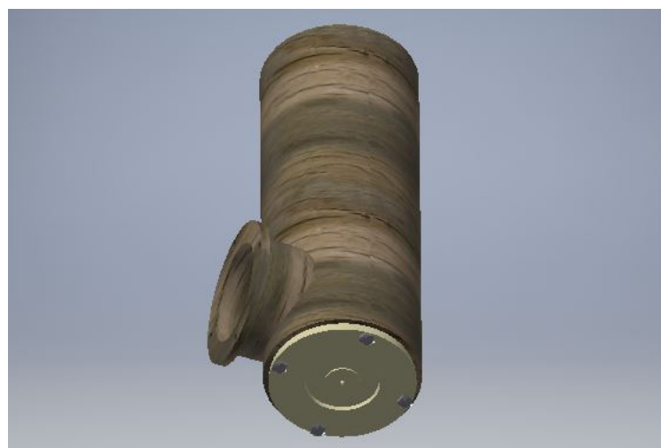
Figura 25: Colocación válvula Clac en base cilindro
