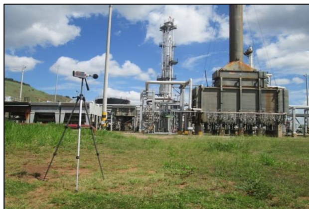
Figura 2. Medición ruido acústico en industria con sonómetro. Fuente: Induanalisis
